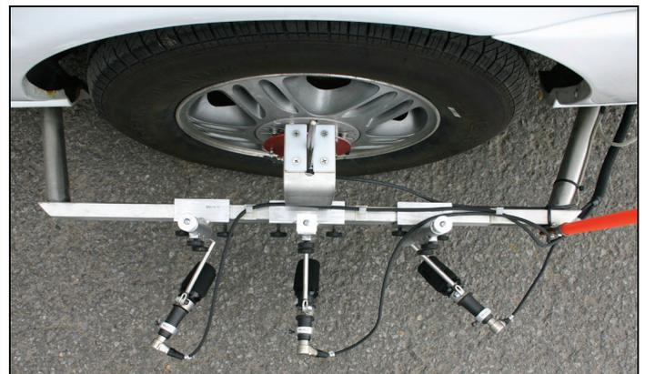
Figure 1 – Position des microphones par rapport au pneu
