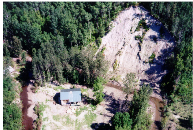
Figure 1 : Glissement superficiel affectant un talus de la rivière Couchepaganiche, 3 e Rang, Métabetchouan, juillet 1996.
