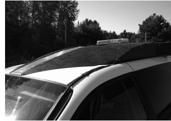
Le CGER a produit un design amélioré de montage de flèche de signalisation pour fourgonnette.
