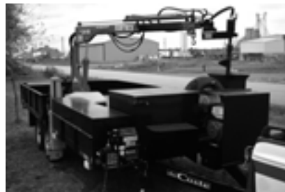
Le CGER a fait l'acquisition de remorques aménagées pour l'entretien des glissières de sécurité.
