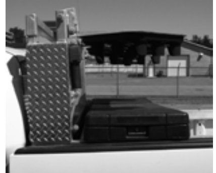
Le CGER offre un nouveau support de flèche de signalisation aérodynamique qui permet une réduction de la consommation de carburant de la camionnette.
