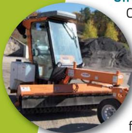
Il possède une cabine chauffée et climatisée, une alarme de recul, une flèche de signalisation, une barre d'éclairage et des lumières de travail. Son réservoir d'eau d'environ 300 litres avec gicleurs est transparent, ce qui permet de toujours voir le niveau. La brosse du balai mesure 2,2 m et sa vitesse de rotation est ajustable.
