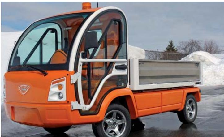
Conçu au Québec, le Nemo est un petit camion électrique plutôt robuste qui peut transporter des charges allant jusqu'à 454 kg. Étant donné que son rayon de braquage est assez petit, il peut être utilisé dans des endroits où d'autres camionnettes ne pourraient circuler.
