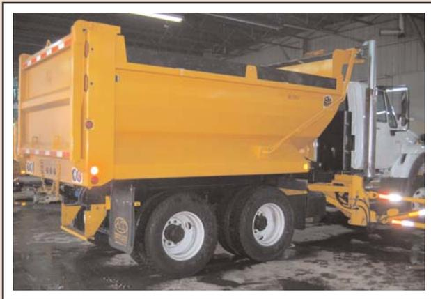
La benne en « U » dont le CGER a fait l'acquisition possède un convoyeur entraîné par un réducteur planétaire qui ne nécessite pas de coiffe. De plus, la géométrie de la trémie favorise l'écoulement des matériaux d'épandage vers le convoyeur, et la présence d'un convoyeur transversal offre une possibilité d'épandage des deux côtés. Un cylindre télescopique permet, quant à lui, de vider rapidement les matériaux d'épandage non utilisés.
