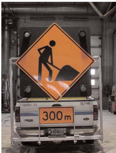
Un premier modèle de panneau, d'une dimension de 1200 x 1200, s'ouvre en deux et est motorisé. En effet, il est actionné électroniquement à partir de l'intérieur du véhicule. Ce panneau est installé en permanence sur les rebords de la caisse, ce qui laisse le fond de la caisse entièrement libre.
