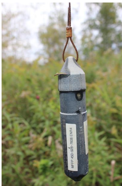
Méthode d'attachement d'un enregistreur
