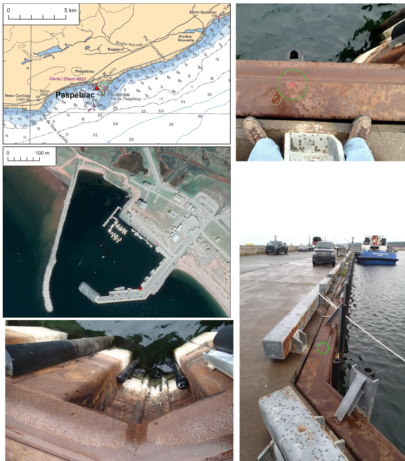
Figure 13 – Marégraphe de Paspébiac. Position du marégraphe sur la carte marine et sur une photographie aérienne du port (point rouge). Droit : point de référence pour les mesures manuelles (croix rouge mise en évidence avec un cercle vert). Bas gauche : les deux tubes ABS au fond desquels sont installés les deux instruments.
