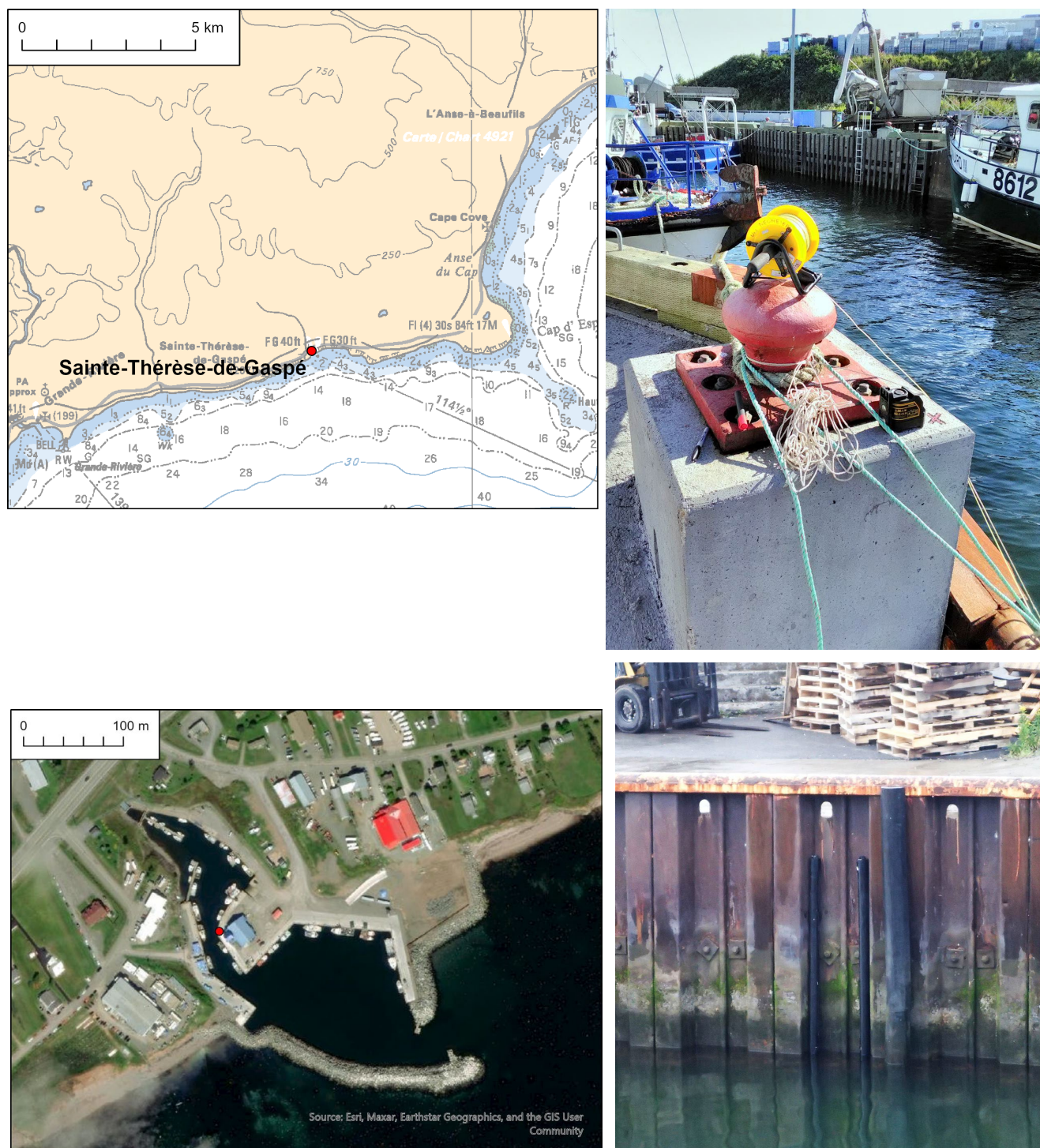
Figure 14 – Marégraphe de Ste-Thérèse-de-Gaspé. Position du marégraphe sur la carte marine et sur une photographie aérienne du port (point rouge). Haut droit : point de référence pour les mesures manuelles (croix rouge sur socle en béton) avec le niveau laser et la sonde Heron Little Dipper. Bas droit : les deux tubes ABS au fond desquels sont installés les deux instruments.
