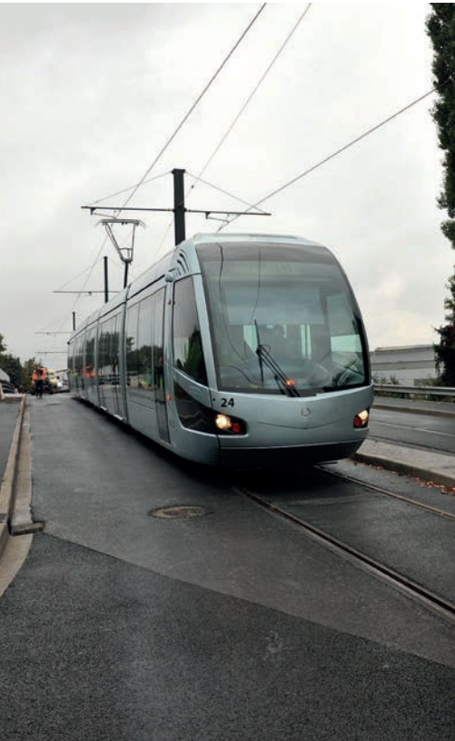
Aménagement à voie unique pour le tramway périurbain de Valenciennes au Pays de Condé Source : SITURV
