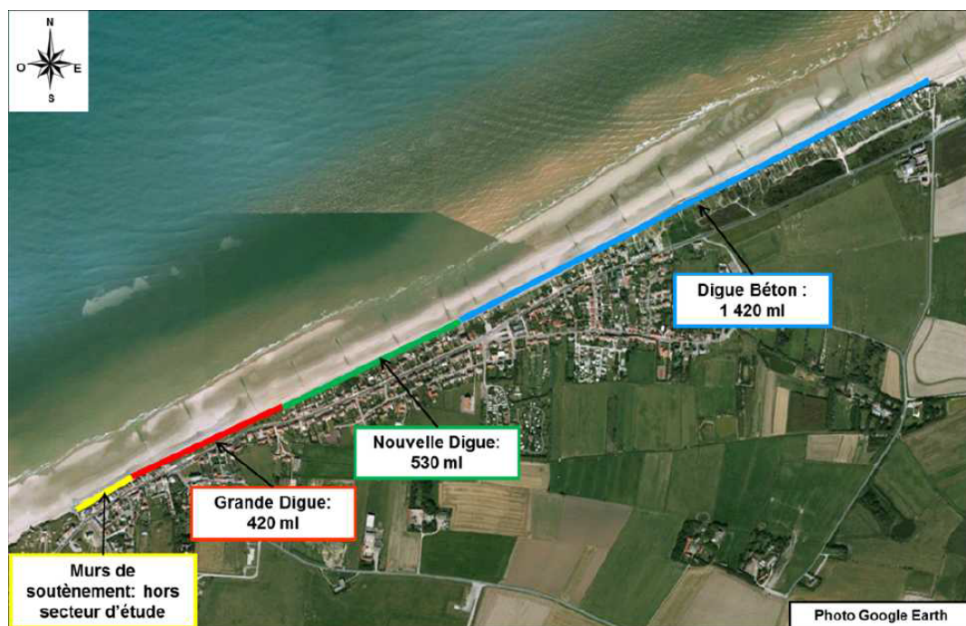
Illustration 64 : localisation des ouvrages à reconstruire (source : DDTM62)
