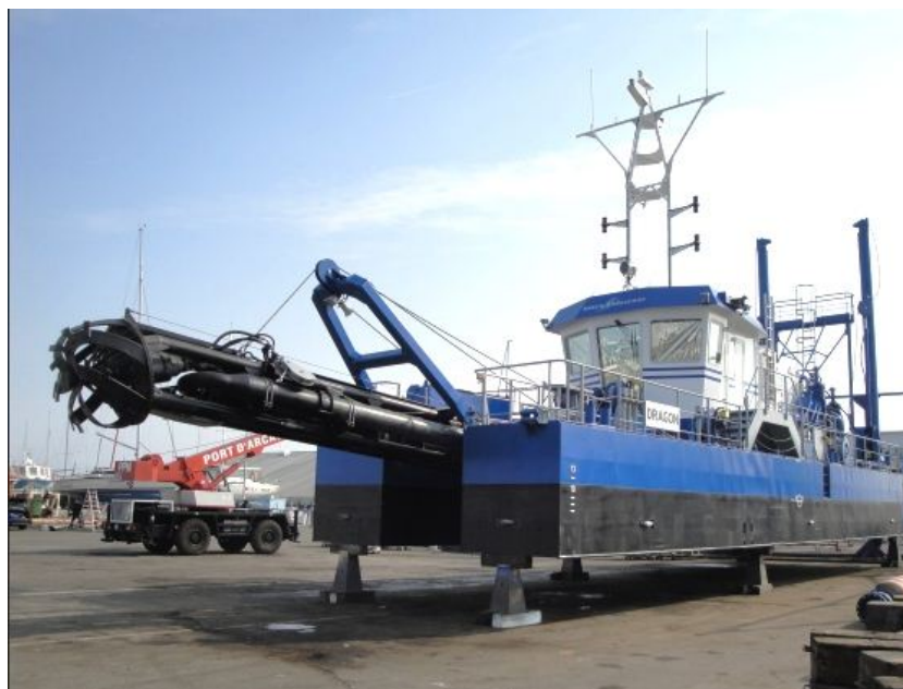
Illustration 32 : drague aspiratrice stationnaire (source : [Syndicat intercommunal du bassin d'Arcachon, 2012])
