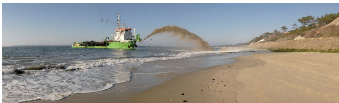
Illustration 33 : drague aspiratrice en marche (source : [Syndicat intercommunal du bassin d'Arcachon, 2012])
