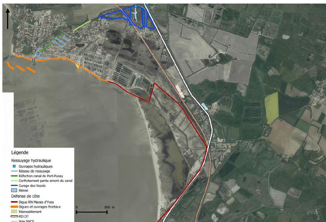
Illustration 27 : plan de masse des aménagements de protection prévus au projet, Creocéan, 2014 (source : Silycaf)
