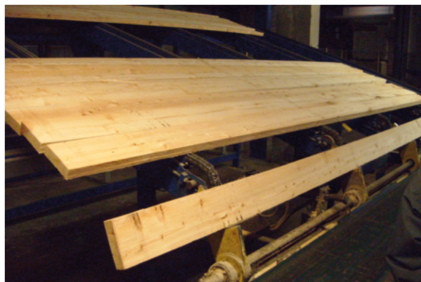
Photo 28 : Contrôle visuel du bois massif (Source : Cerema)
