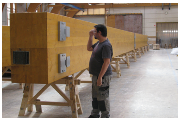
Photo 39 : Réception d'un bloc de six poutres en usine (Source : Cerema)
