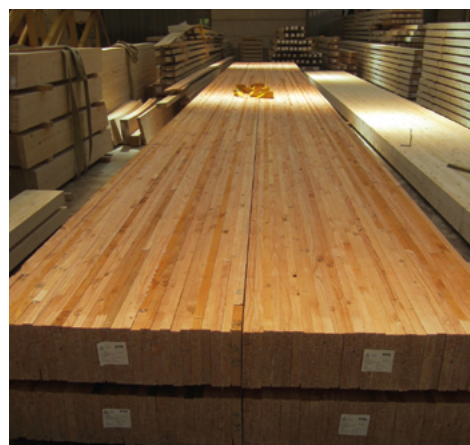
Photo 30 : Stockage de poutres bois lamellé-collé en usine (Source : Arbonis)
