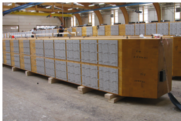
Photo 40 : Bloc de 6 poutres équipé de ses plaques de connexion (Source : Cerema)
