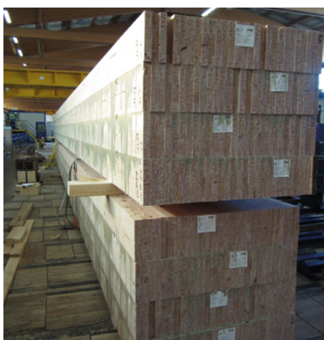
Photo 37 : Stockage de blocs de quatre poutres unitaires (Source : Arbonis)
