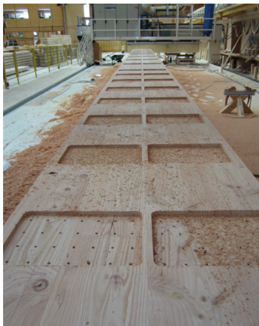
Photo 9 : Engravures dans les nervures en bois pour logement des plaques de connexion (Source : Arbonis)
