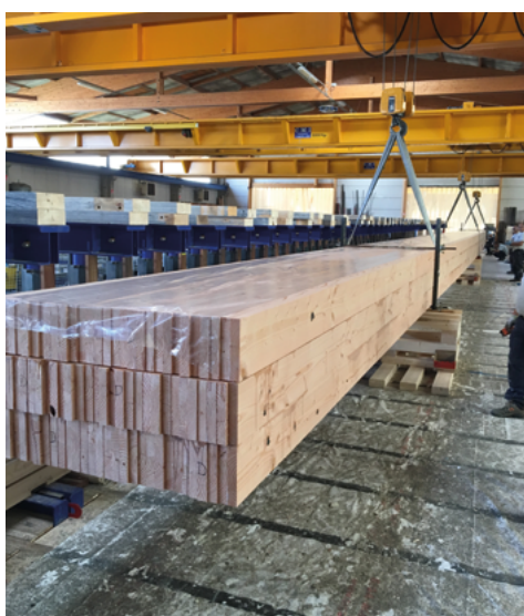
Photo 33 : Prise en charge par pont roulant d'un bloc de trois poutres unitaire (Source : Arbonis)
