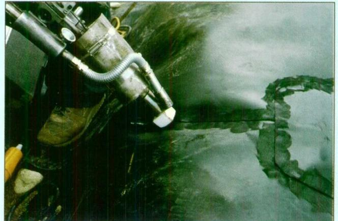
*Soudure par extrusion de PEHD (pièces de raccordement)*
