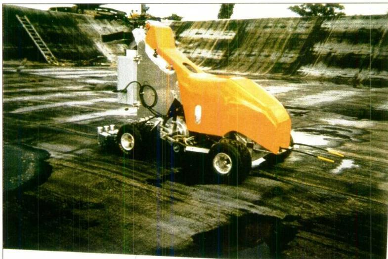
*Contrôle ultra-sons à grand rendement sur géomembrane bitumineuse*
