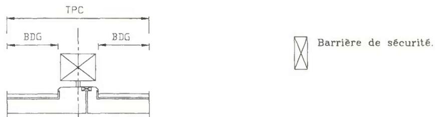
Figure 66 - Un dispositif central
