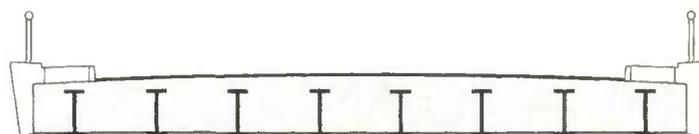
Figure 213 - Pont à poutrelles enrobées
