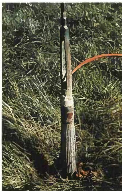
Figure 104 - Sonde pressiométrique
