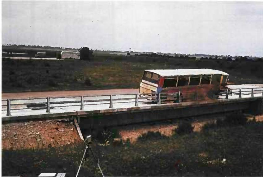
Figure 37 - Essai de choc sur dispositif de retenue
