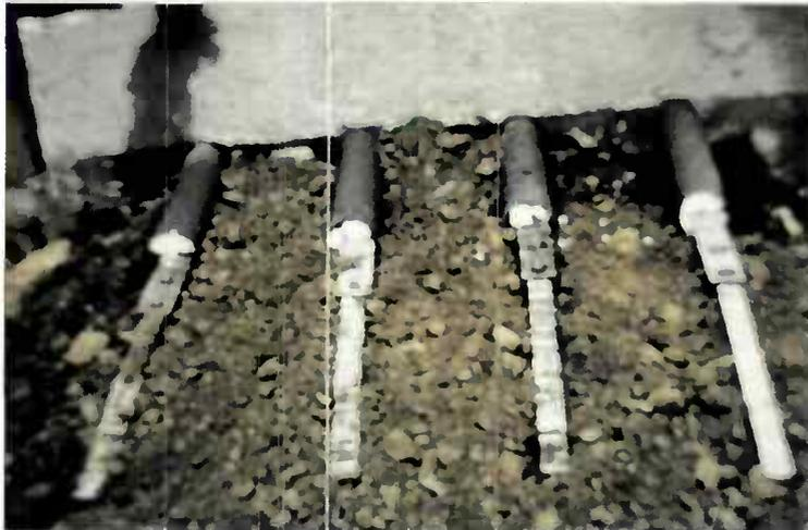
Figure 2.29 : Témoins de durabilité extractibles d'éléments de renforcement métalliques
