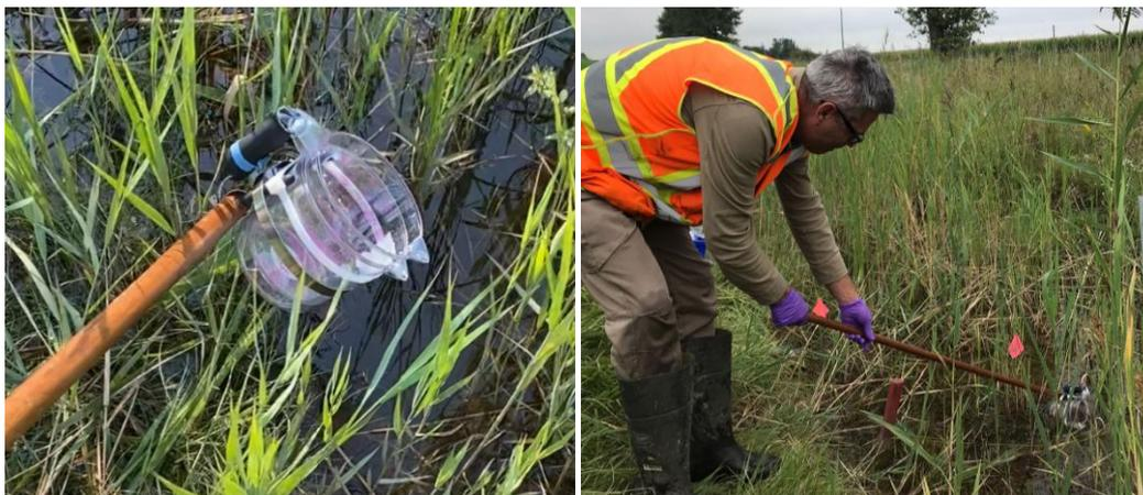
Figure 14. Pichet monté au bout d'un bâton
