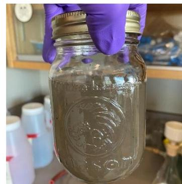
**Figure 16. Pot Mason servant pour l'analyse des MES et des données prises avec la sonde Hanna**
