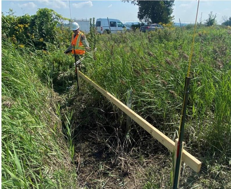
**Figure 10. Planche de bois servant à la mesure de la section transversale du fossé**
