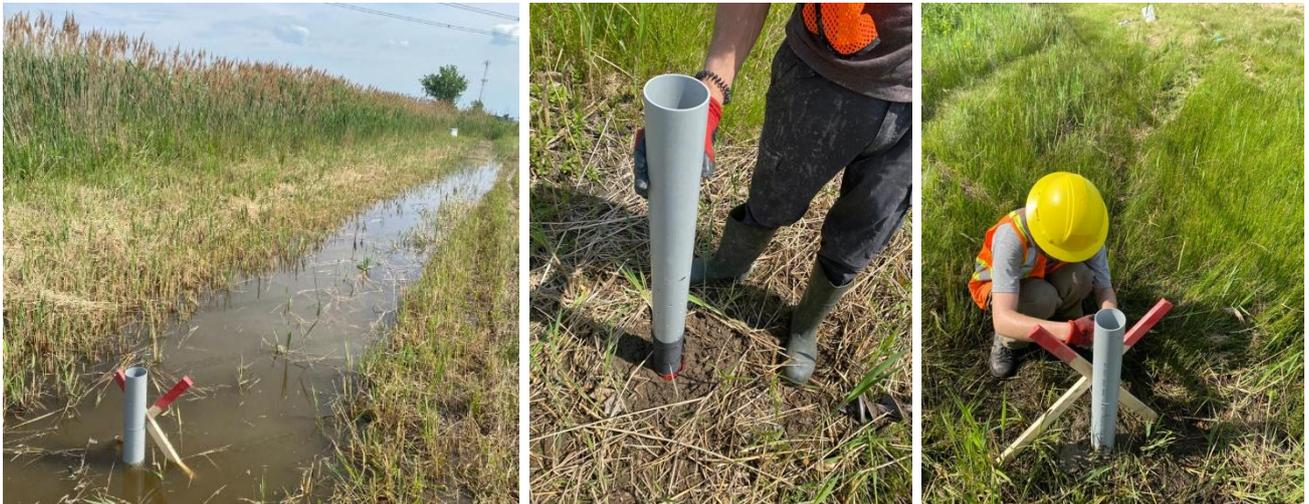
**Figure 8. Tubes en PVC servant de supports à l'appareil de mesure de hauteur d'eau sur le site J5 à gauche**
