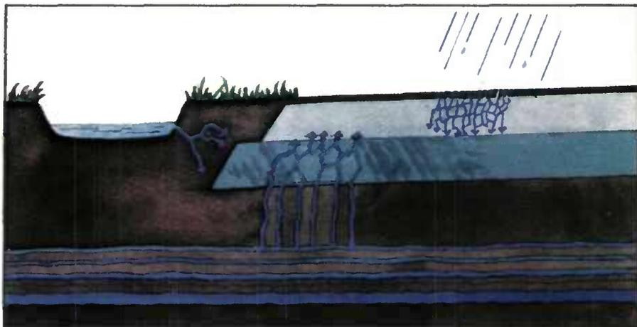
**Une même charge supportée par une chaussée entraîne une déformation beaucoup plus importante sur un sol humide que sur un sol sec.**
