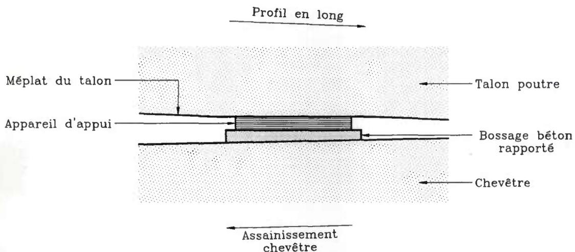
FIGURE 90 : Cas 1 - Méplat de la fibre inférieure du talon
