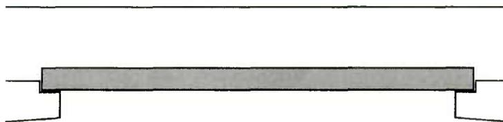
FIGURE 63 : Prédalle en béton armé
