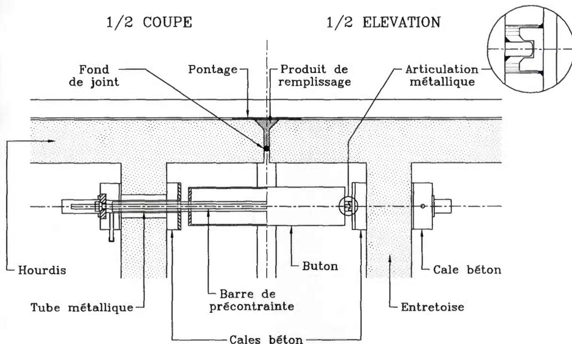
FIGURE 88 : Principe d'attelage par tirants-butons
