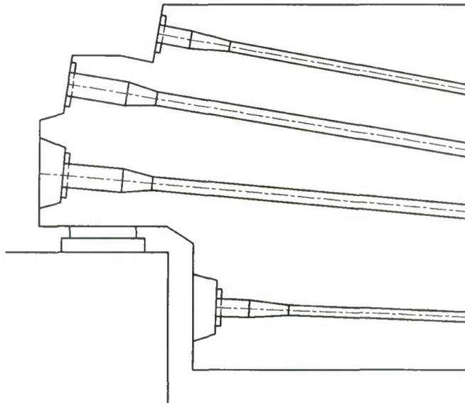
FIGURE 46 : *Echancrure de l'extrémité des poutres*
