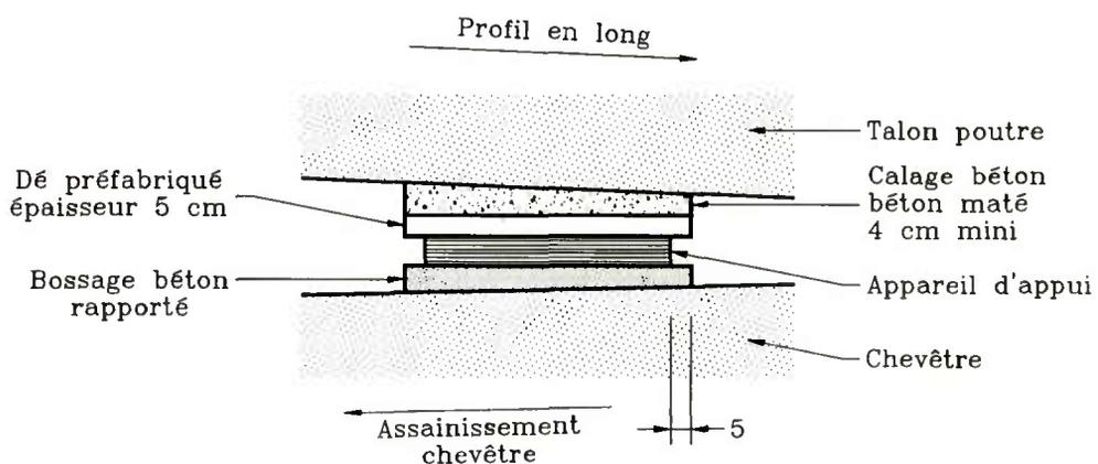
FIGURE 92 : Cas 3 - Calage de l'appareil d'appui par matage
