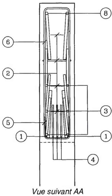
FIGURE 82 : Principe de ferrillage d'une entretoise
