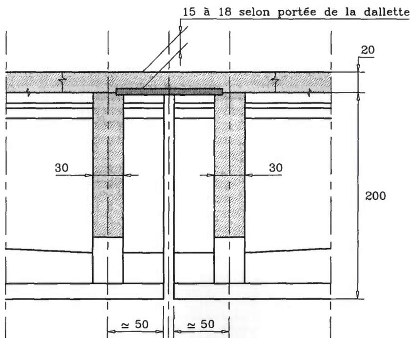
FIGURE 84 : Principe de continuité apparente par dalle de continuité (cotes indicatives)
