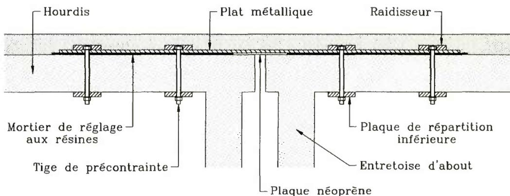
FIGURE 87 : Exemple d'attelage par plats métalliques boulonnés
