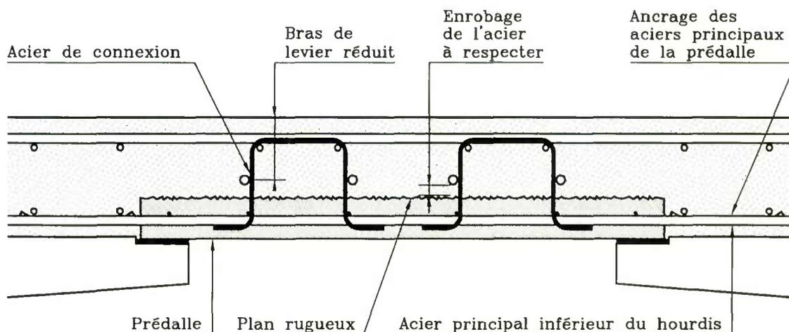
FIGURE 77 : Principe de ferrailage du hourdis sur prédalle participante
