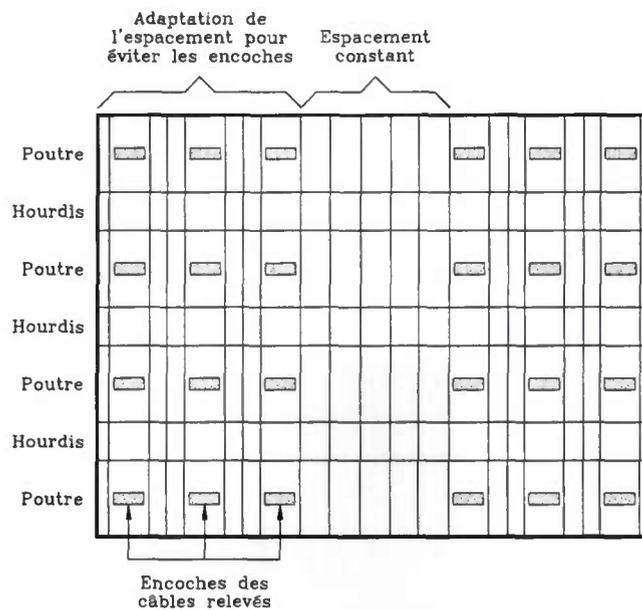
FIGURE 68 : Principe d'une précontrainte transversale
