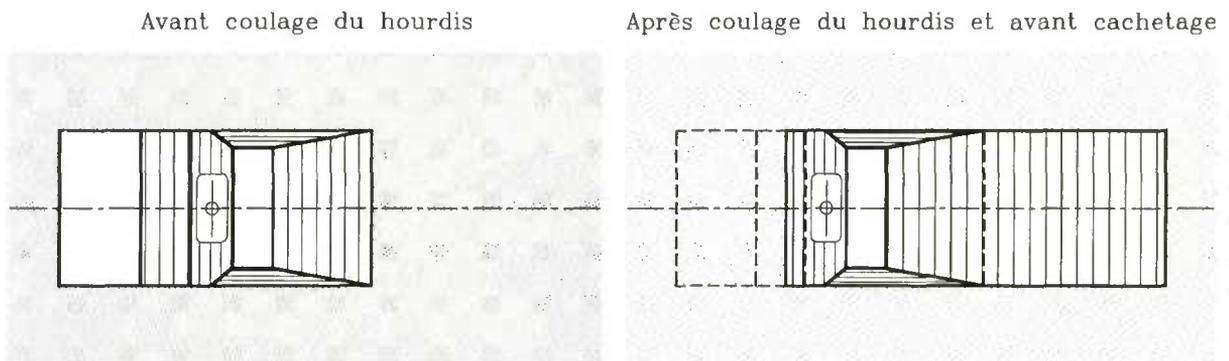
FIGURE 67 : Principe d'une encoche de câble relevé dans le cas d'un hourdis général
