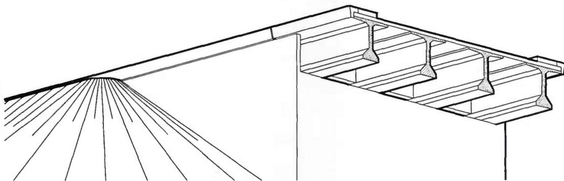
FIGURE 1 : Morphologie générale d'un tablier
