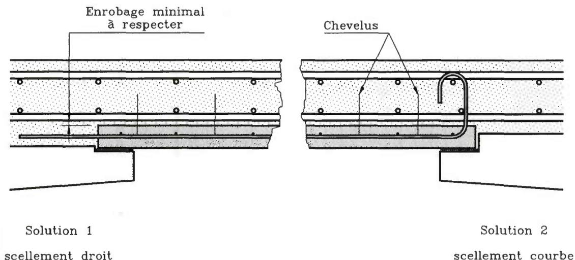
FIGURE 75 : Principe de ferrailage du hourdis sur prédalle non participante
