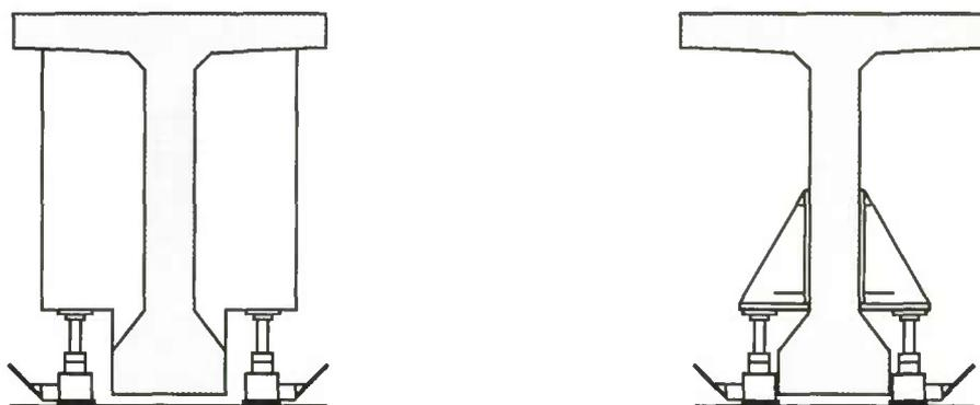
FIGURE 107 : Soulèvement des poutres par amorces ou fausses amorces
