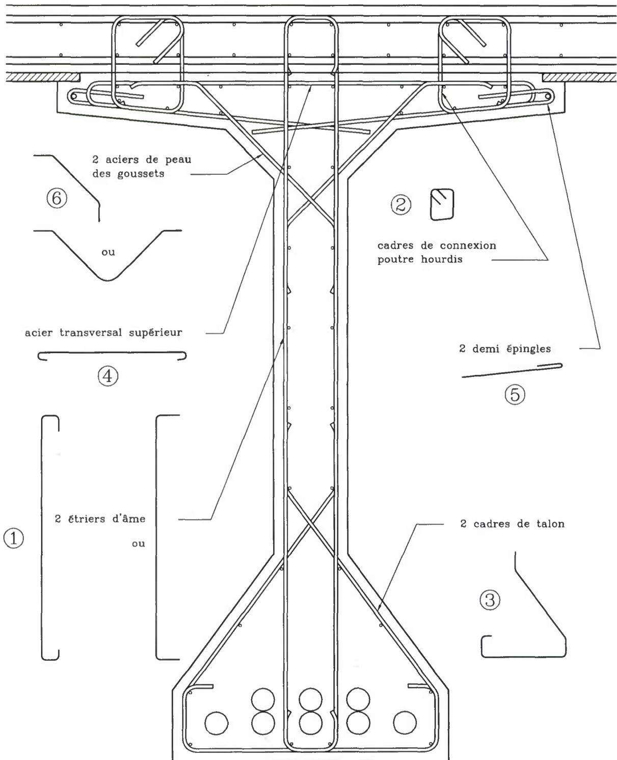
FIGURE 72 : Principe de ferrailage d'une poutre
