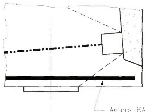
FIGURE 56 : Diffusion des efforts vers l'appareil d'appui
