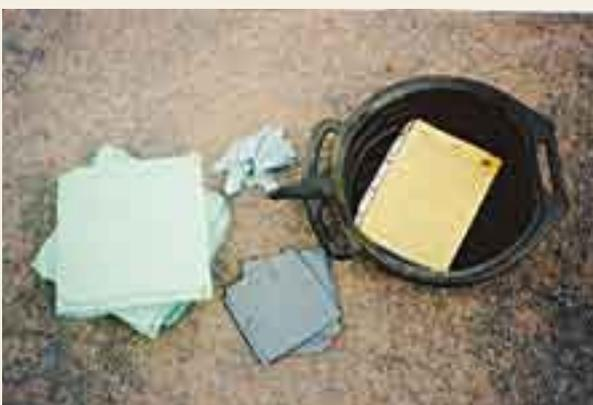
Photos 35, 36, 37 : produits absorbants en atelier et pour l'entretien d'engins sur chantier (Source : GTM Terrassement)
