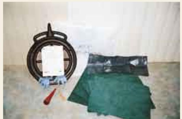
Photo 38 : kit antipollution pour véhicule de chantier
