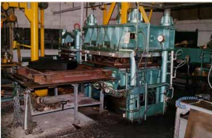
Figure 2.2 : vue d'une presse au démoulage (photo SNAC)
