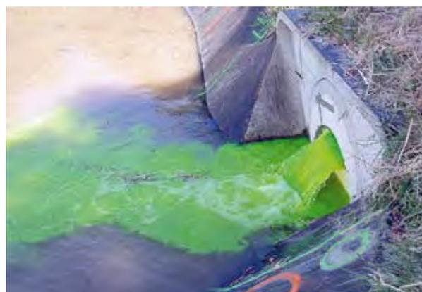
Photo n°1 : simulation de déversement accidentel à la fluorescéine
