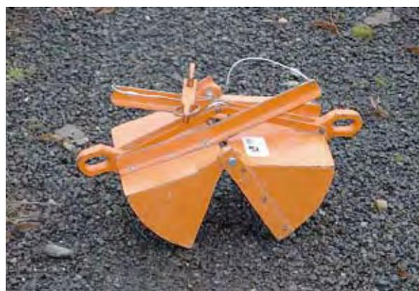
Photo n° 5 : benne à sédiments – Source : CETE de l'Est
