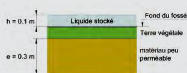
Schéma n° 15 : dispositif d'étanchéité en matériau naturel
