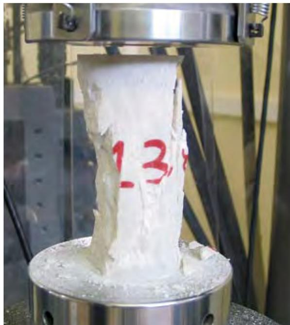
Figure 3.13 : essai de compression uniaxiale - Carotte de diamètre 50 mm - Marbre de Saint Béat - Source : LRPC Toulouse
