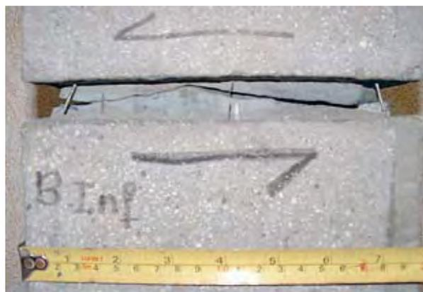
Figure 3.14 : essai de cisaillement sur discontinuité rocheuse - Source : LRPC Lyon
