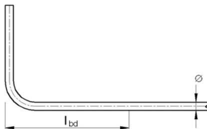
Fig./Tab.3.(1) : Ancrage courbe d'une barre comprimée
