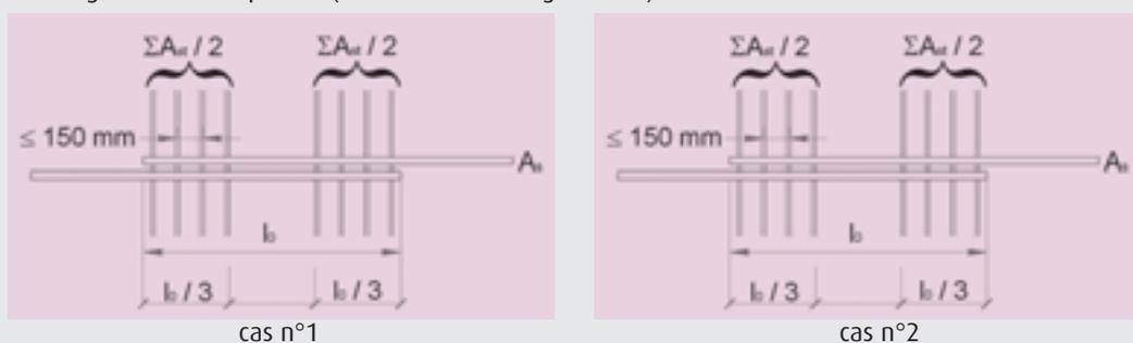
Figure 3.44 – Dispositions possibles des armatures transversales dans une zone de recouvrement de barres tendues de diamètre supérieur ou égal à 20 mm
