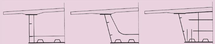
Figure 2.15 – Éléments transversaux : à gauche et au centre, cadres ; à droite, diaphragme sur appuis
