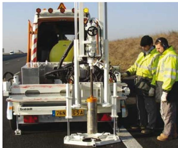
Illustrations 4 - Exemple de coupe de sondage, photo de carotte, et de carottage de chaussée (LRPC Blois)
