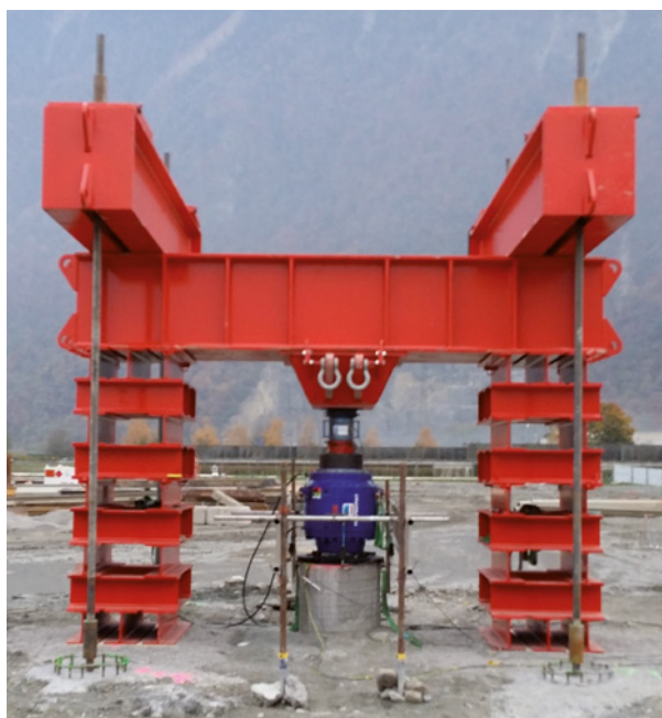
Figure 6.33 : Essai de chargement en compression
