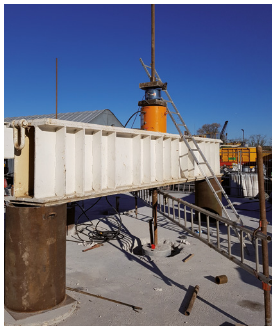
Figure 6.34 : Essai de chargement en traction
