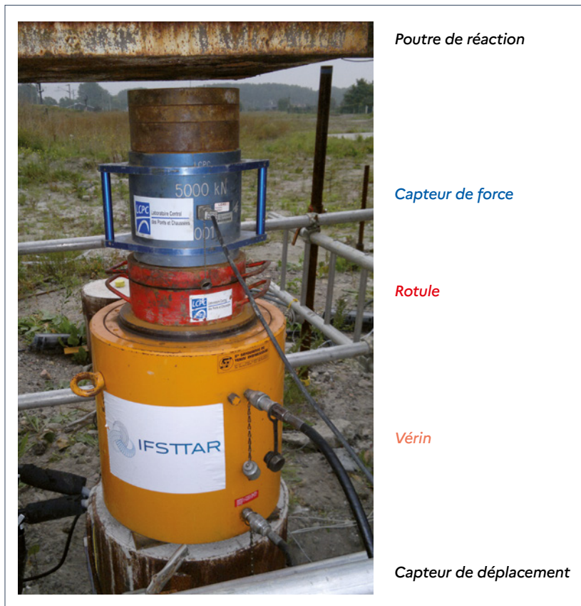
Figure 6.36 : Système d'application de l'effort
