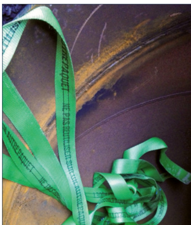
Figure 5.82 : Sangle de manutention en polyester à usage unique
