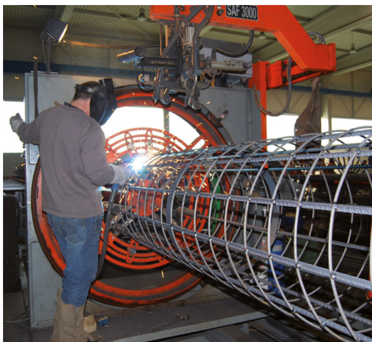
Figure 5.60 : Machine d'assemblage des aciers en usine
