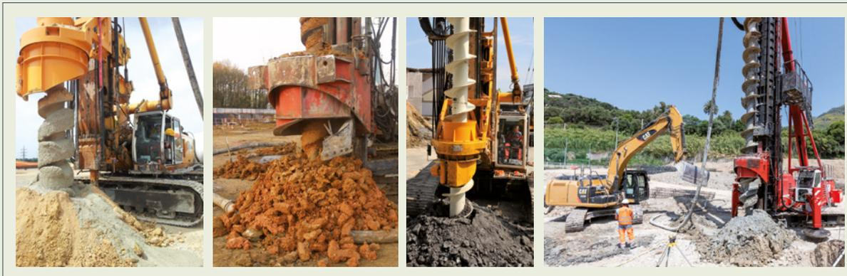
**Figure 3.57 : Photos de systèmes de décrotteurs passifs ou actifs des pieux tarière creuse simple rotation (classe 2)**
