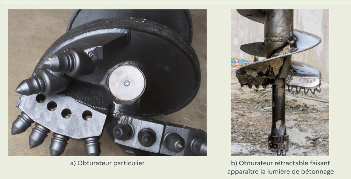
Figure 3.54 : Phasage de forage et bétonnage pour les pieux forés à la tarière creuse équipée d'un obturateur rétractable (schémas de principe)
