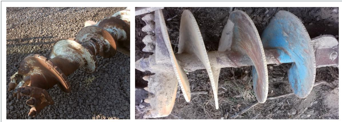
Figure 3.37 : Exemples de tarière pour la réalisation des pieux de classe 1
