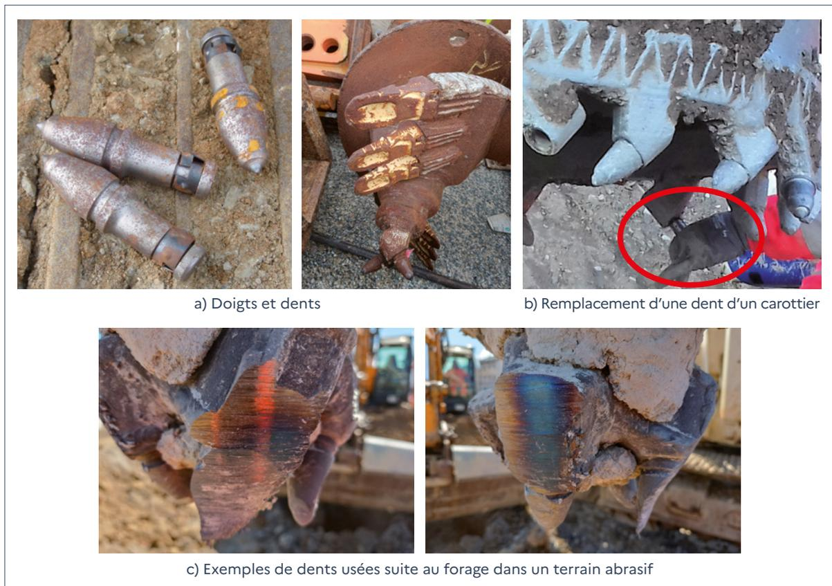
**Figure 3.35 : Exemples de pointe d'attaque appelée aussi mèche ou outil pilote à la base de l'axe de la tarière**
