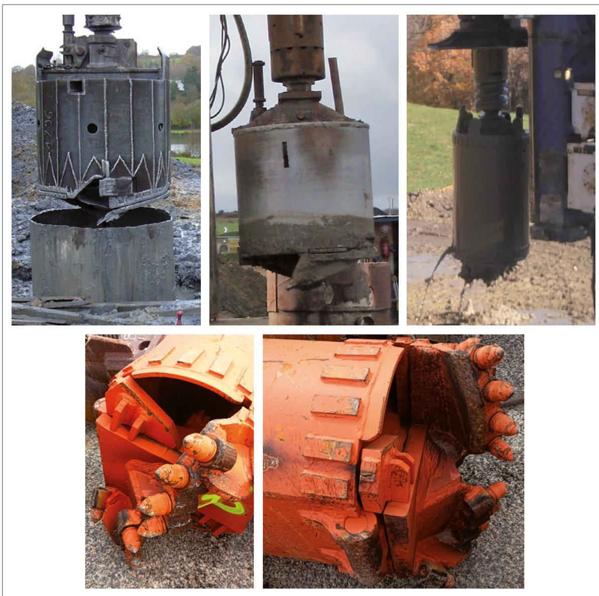
Figure 3.43 : Exemples d'utilisation de godets de forage à fond plat
