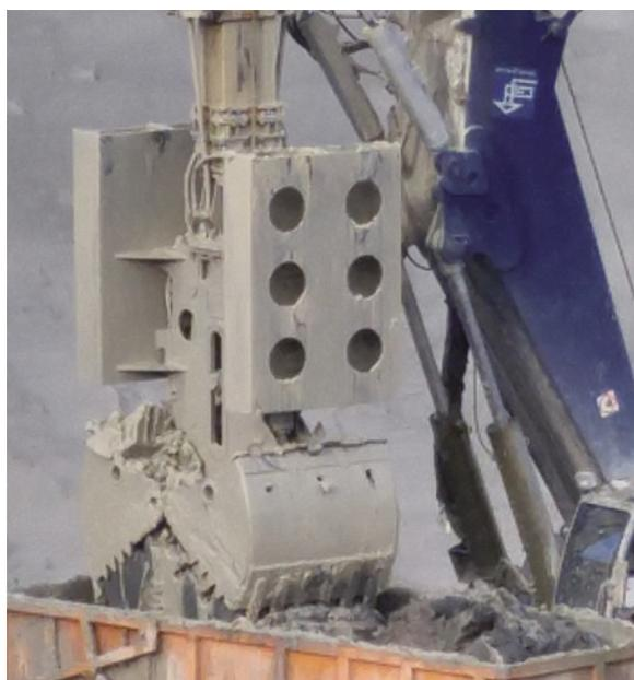
**Figure 3.66 : Benne preneuse à coquilles rondes suspendue à un câble**
