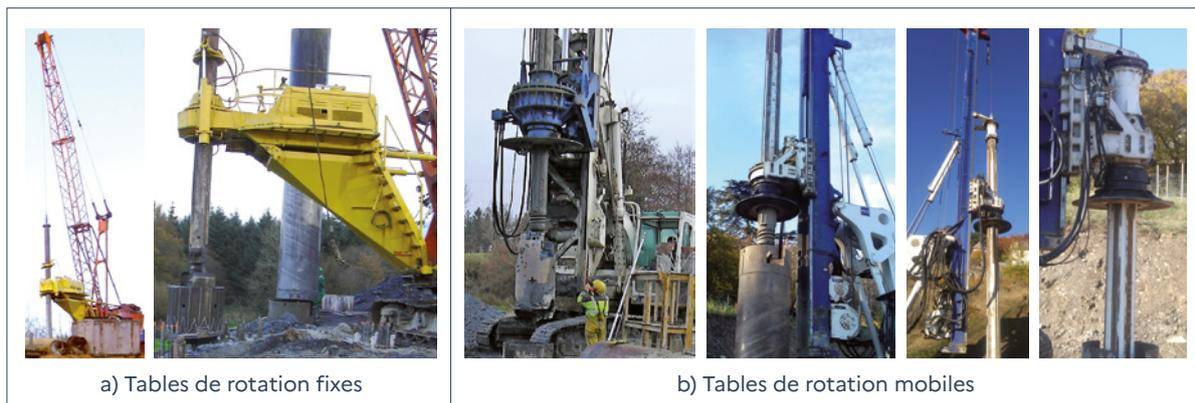
Figure 3.19 : Exemples de louvoyeuse permettant l'enfoncement et le retrait des tubes pour la réalisation des pieux forés tubés de gros diamètre ou de grande longueur (cf. « Mise en œuvre des tubes et précautions associés » dans le § 5.2.2 « Les tubes récupérés ou perdus »)
