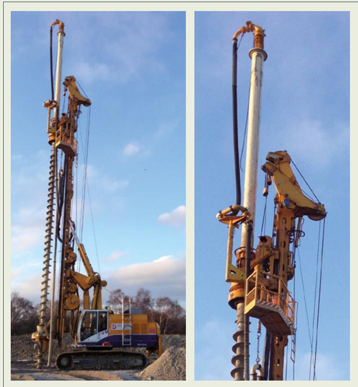
Figure 3.50 : Exemples d'outils spécifiques de forage et de segments de tarière creuse
