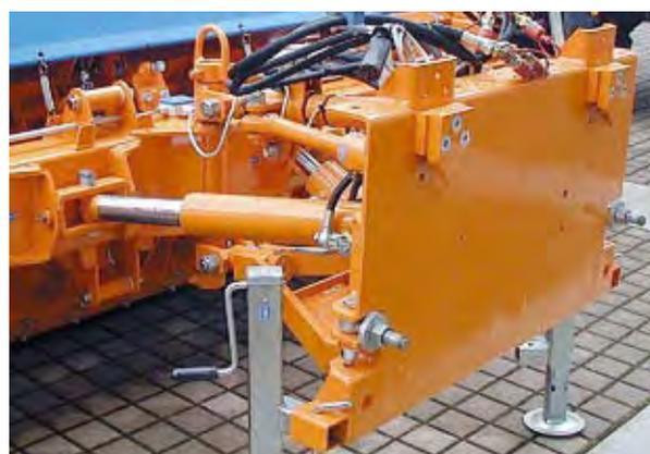
Liaisons porteur-outils : plaque de base, vérins d'orientation, flexible hydraulique - Source : CFE Normandie-Centre/SEMR
