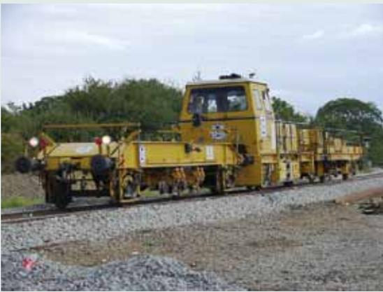
Le **Stabilisateur dynamique** est une machine servant à compacter le ballast par vibration pour assurer sa bonne stabilisation et donc un bon ancrage de la voie.
