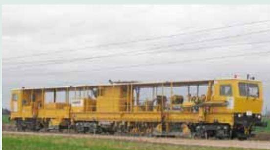
La **Traveleuse** est un engin permettant de positionner régulièrement les rails et les traverses.
