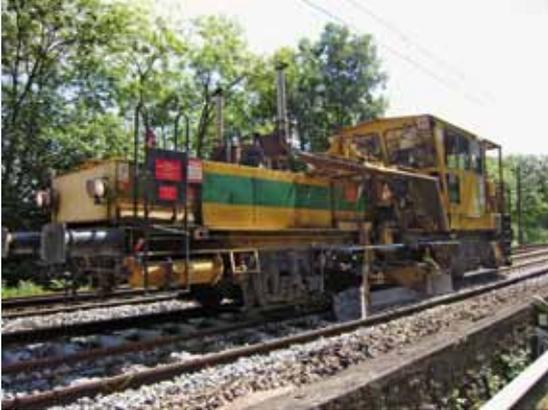
La **Régaleuse** sert à réaliser un nivellement du ballast de chaque côté de la voie.
