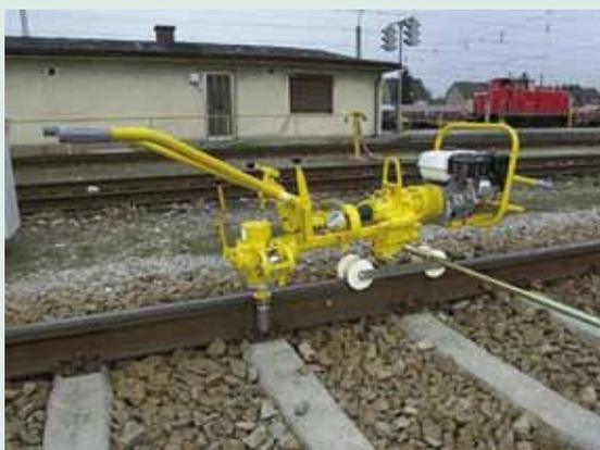
La **Tirefonneuse** sert à fixer les long rail sur les traverses.
