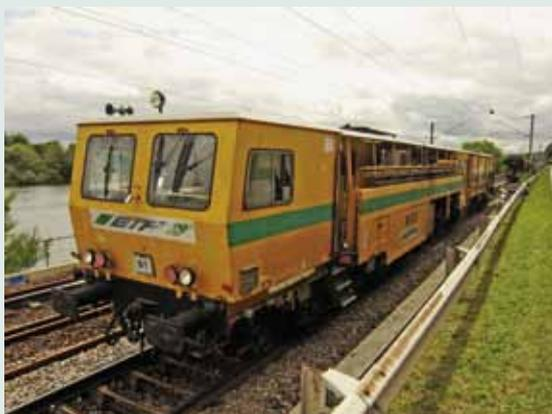
La **Bourreuse** ou bourreuse-dresseuse-auto-niveleuse est une machine servant à compacter le ballast sous les traverses. Elle le compacte grâce à des battes métalliques vibrantes. Elle effectue aussi une opération de nivelage.
