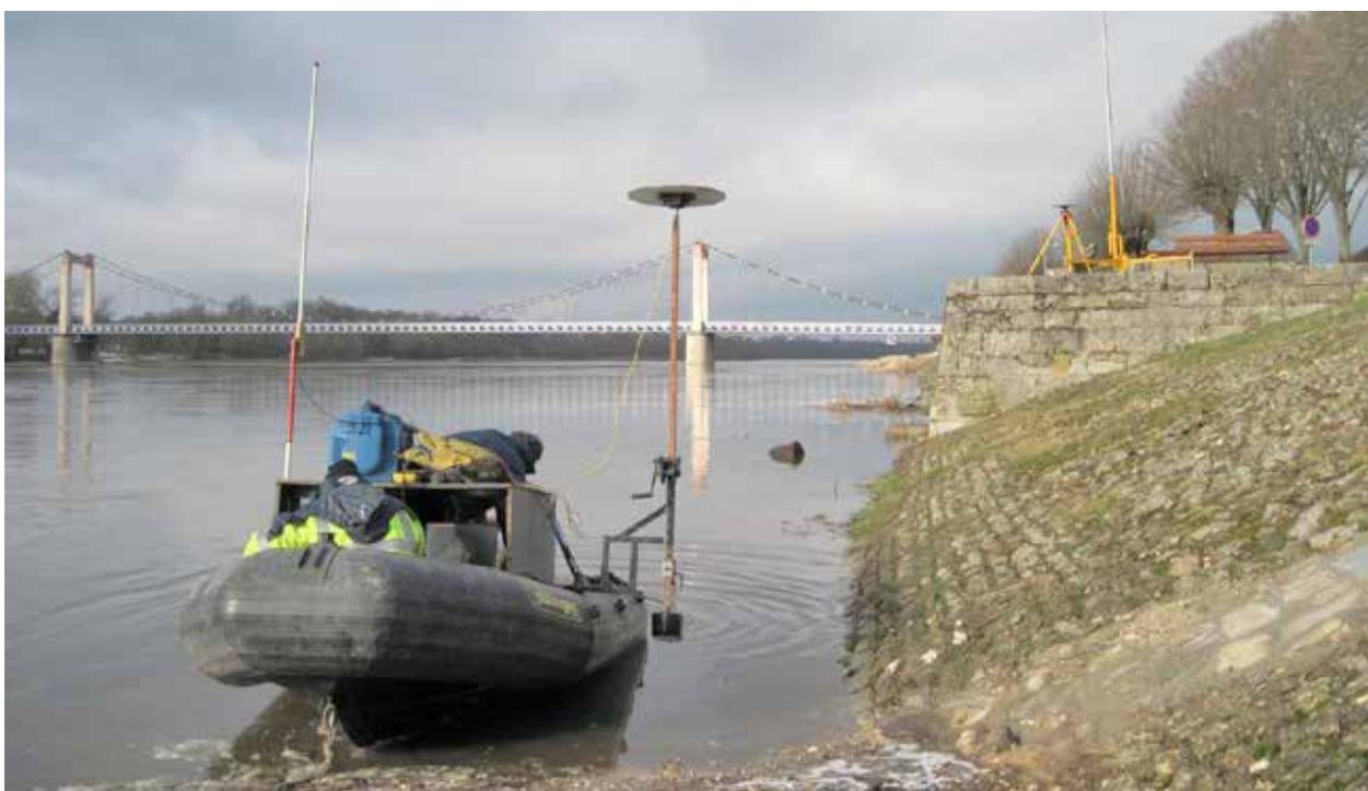
Figure 10 : Matériel utilisé pour le levé bathymétrique (Photo : CETE Normandie-Centre)
