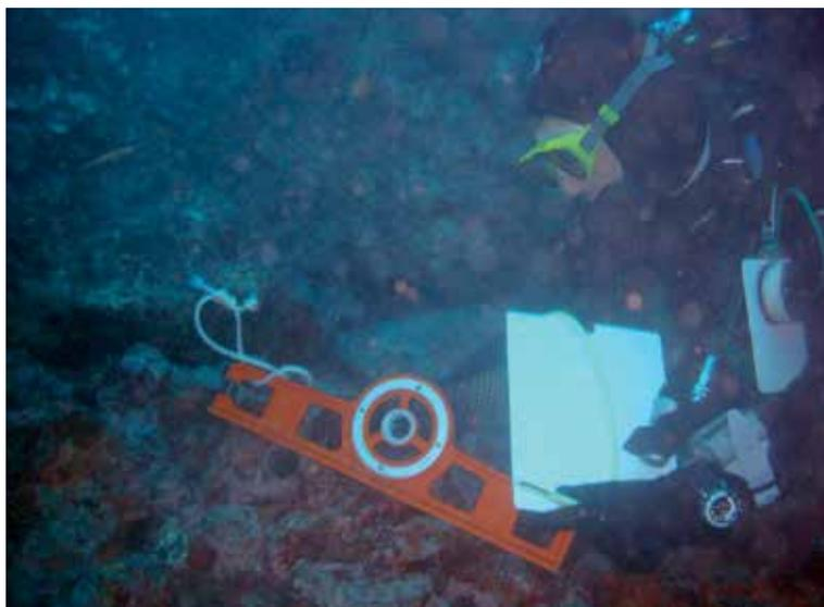
Figure 9 : Inspection subaquatique, relevé de désordres
