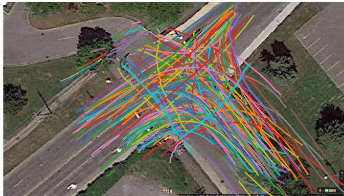
**Figure 11 : Exemple des prototypes extraits à l'intersection de Montcalm et Marie-Victorin**
