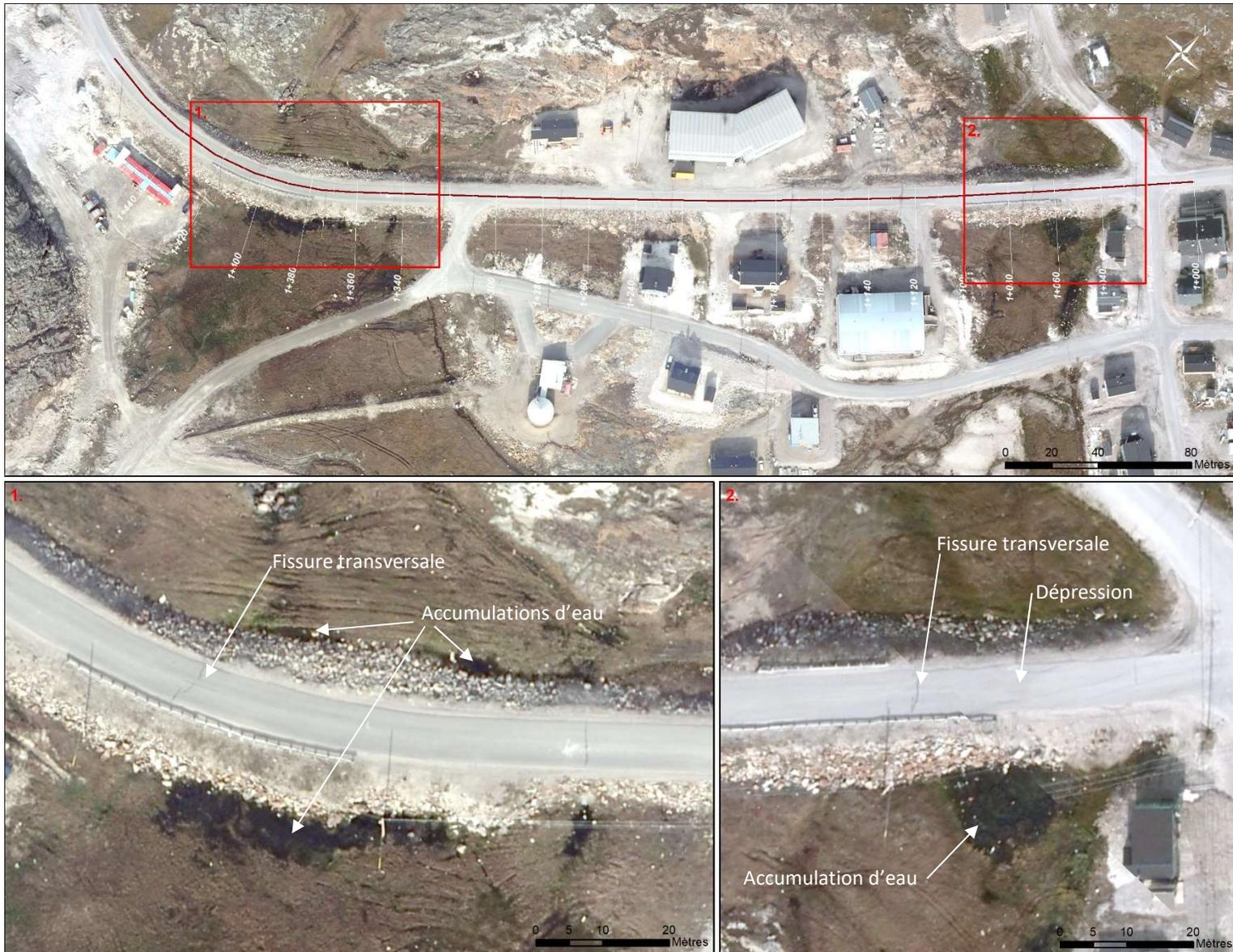
Figure 120 : Évidences de dégradation du pergélisol et défauts observés à partir des photos aériennes prise en 2010, route d'accès à l'aéroport d'Iqaluit.
