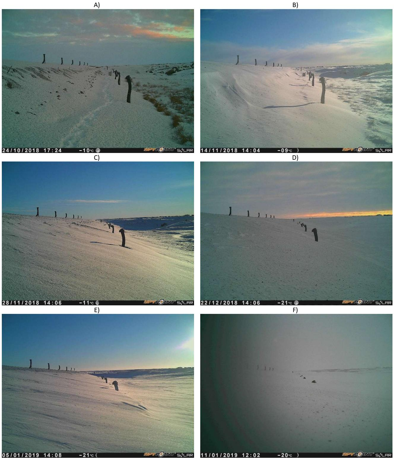
Figure 32 : Suivi photographique des conditions d'enneigement en marge de la piste d'atterrissage de Puvirnituk côté amont pour l'hiver 2018-2019, caméra automatisée PuvCam-4. Conditions d'enneigement au cours de l'hiver 2018-2019 au A) 24 octobre, B) 14 novembre, C) 28 novembre, D) 22 décembre, E) 5 janvier et F) 11 janvier. À noter que la date apparaissant sur l'image F est erronée en raison du dérèglement de l'horloge interne de la caméra.
