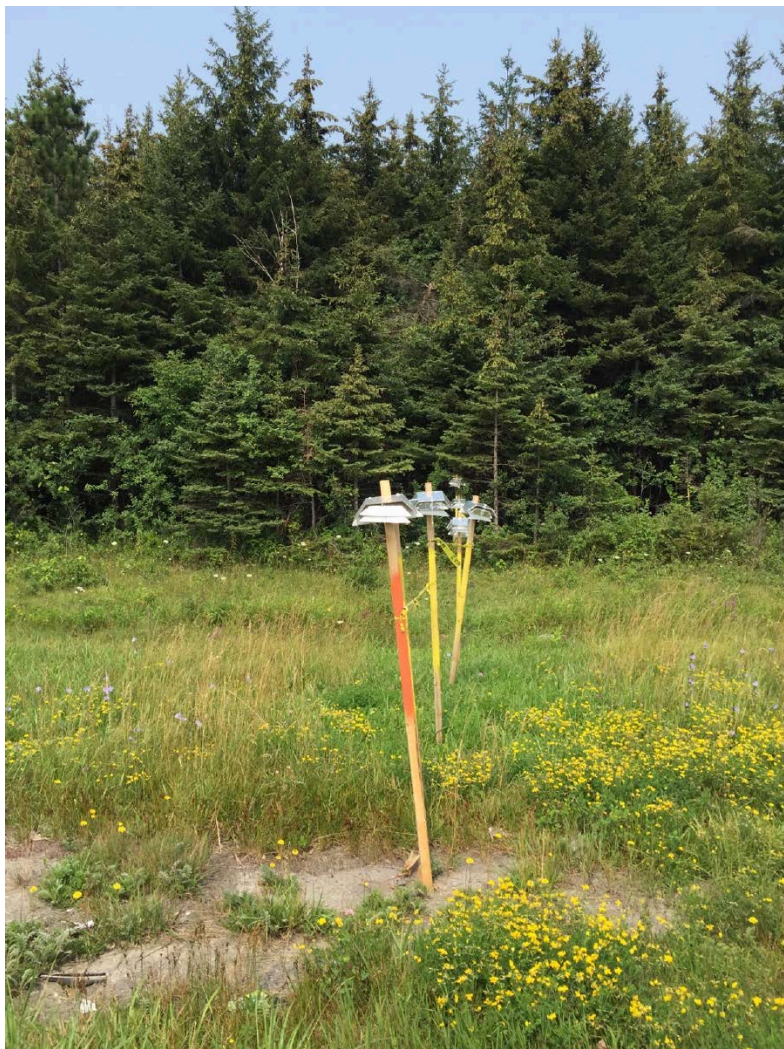
Figure 19 Exemple de transect de sondes de température. Photo : Hugo Ouellet.
