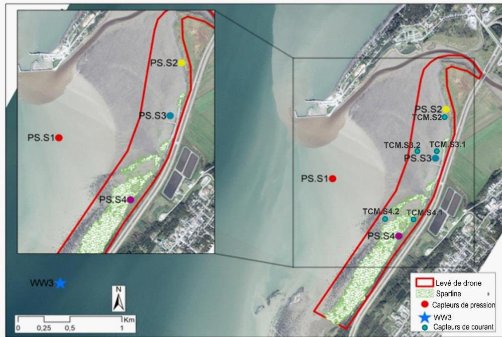
Figure 13. Carte de localisation des instruments déployés dans la zone intertidale de la baie de Rivière-du-Loup. Le polygone rouge indique la zone de survol par drone et l'étoile indique le point de grille WW3.
