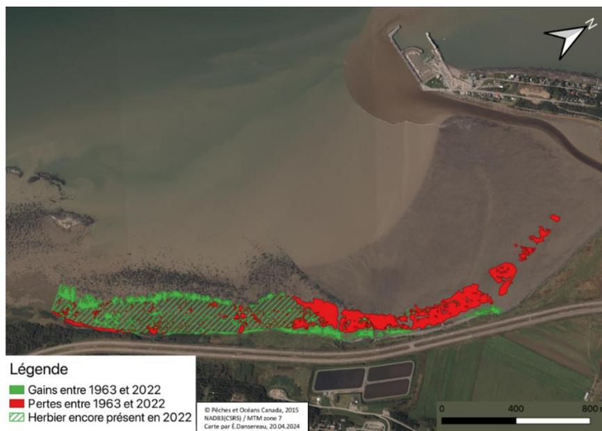
Figure 46. Photo-interprétation de l'herbier de spartine au marais de RDL, montrant les zones perdues, gagnées et stables au fil du temps, basée sur l'analyse de l'image satellite de 1963 et du relevé par drone de 2022.
