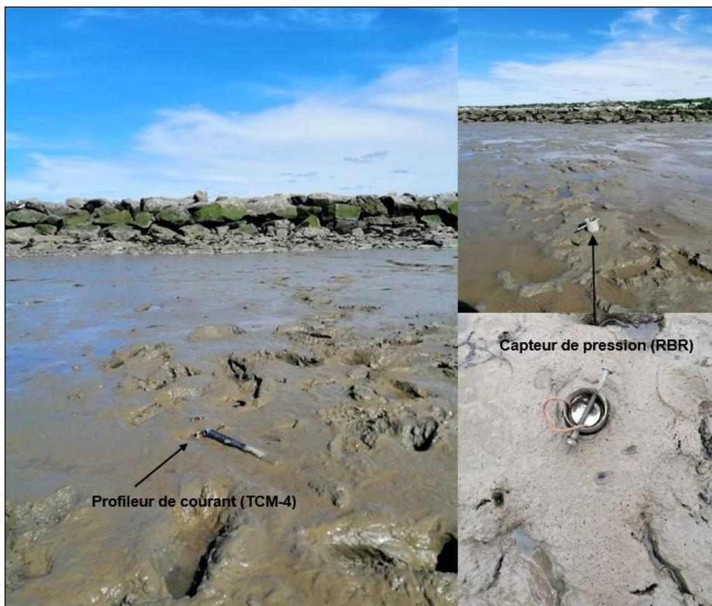
Figure 15. Mode d'installation des courantomètres (à gauche) et des capteurs de pression (à droite) sur le bas marais de RDL.
