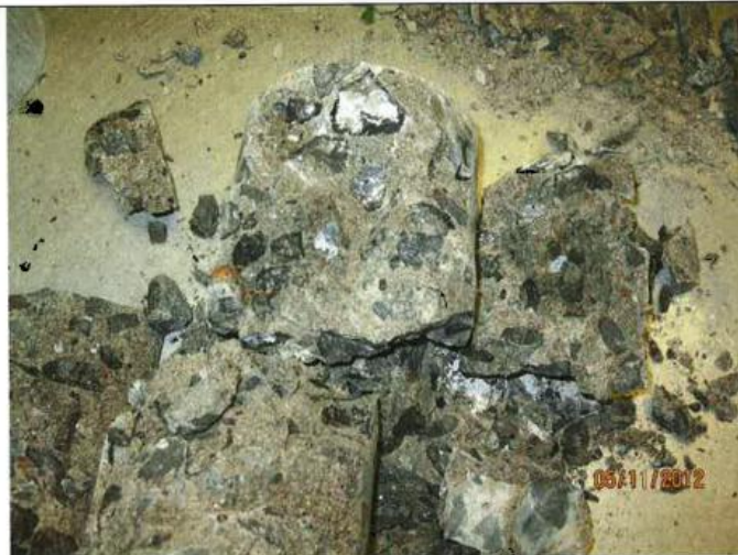
Présence de réaction alcalis-granulats dans la carotte C-5.
