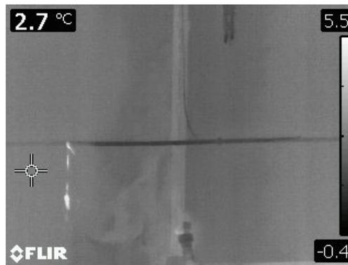
**Figure 58** Exemple de thermographie infrarouge pour le joint du chaînage 28+35. Le cadrage de la thermographie correspond approximativement à celui de la photographie de la Figure 52a.
