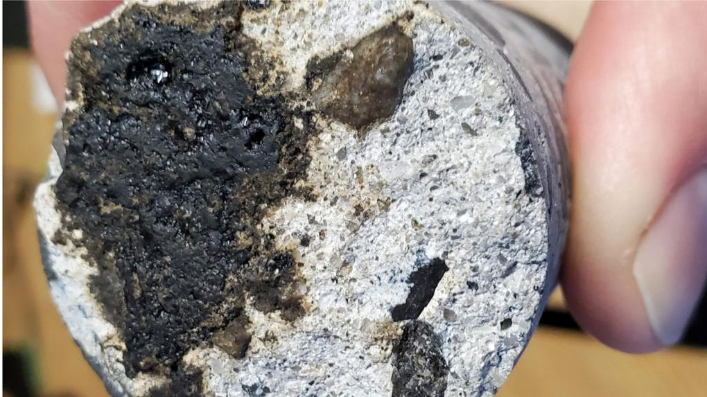
**Figure 11** Exemple de membrane bitumeuse à l'extrémité d'une carotte de la structure du couloir d'évacuation entre les tours 12 et 13.
