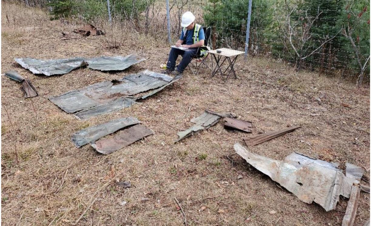
Figure 34: Analyse des tôles de toiture au terrain, vers le sud-est
