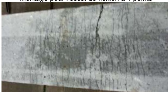
Multifissuration observable après humidification des échantillons
