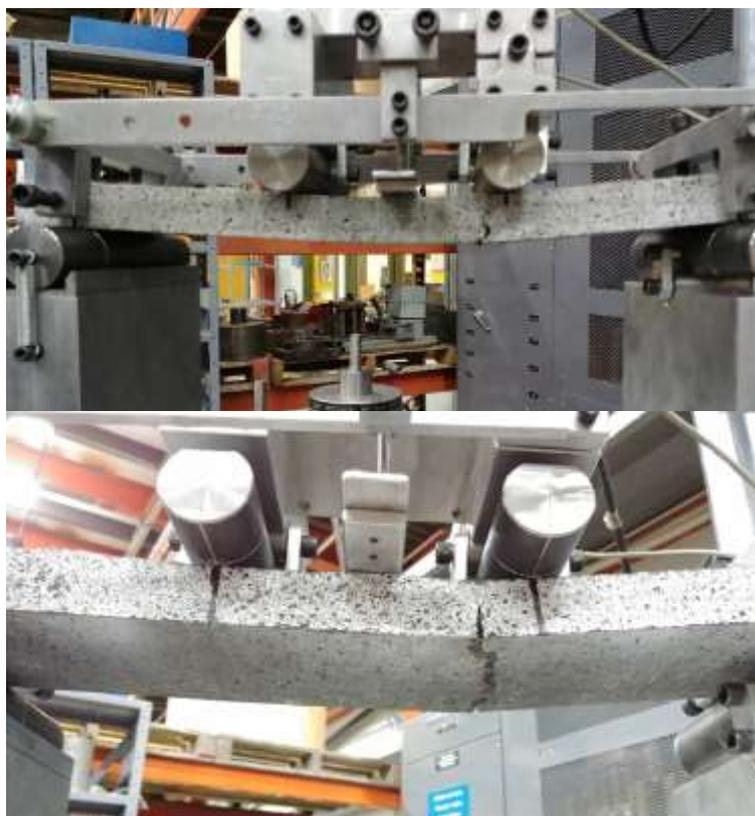
**Figure 37 Essai de flexion à 4 points sur dalles minces**
