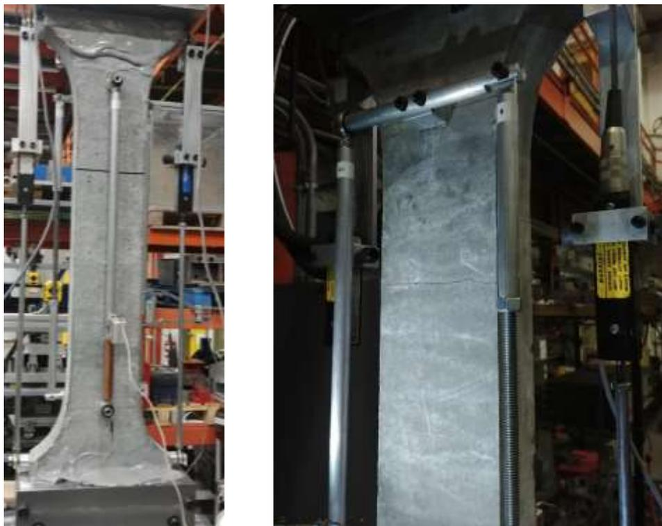
Figure 42 Résultats de divers essais de traction directe. Après la microfissuration, une large fissure visible à l'œil a localisé à la fin de l'essai dans la zone centrale.
