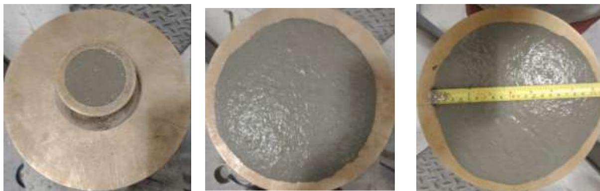
**Figure 28 Cône à mortier et table d'étalement utilisés afin d'assurer un comportement similaire à celui prescrit par le fabricant**
