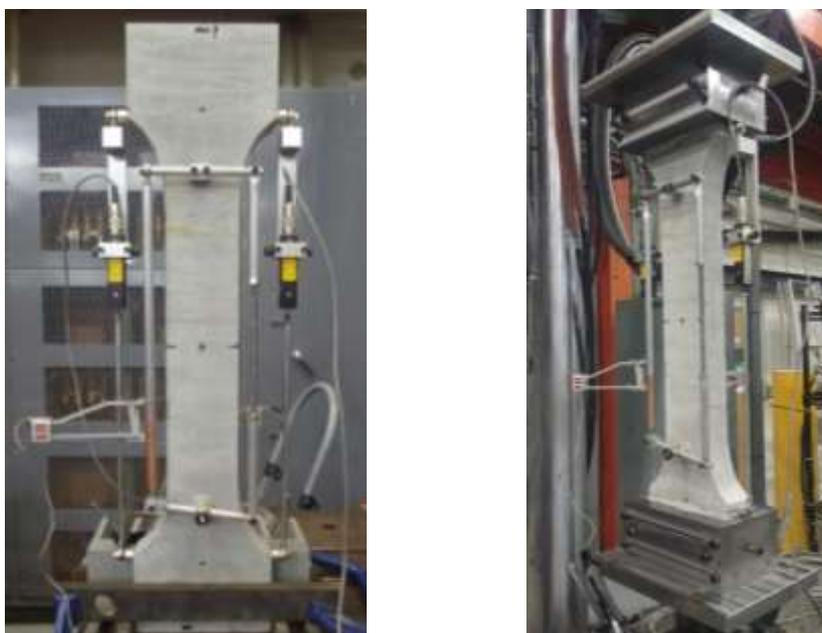
**Figure 40 Instrumentation pour les échantillons de traction directe**
