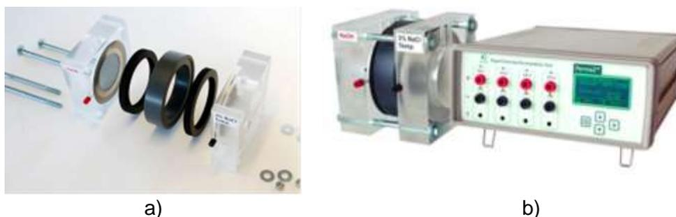
Figure 27 Essai de migration accélérée des ions chlorure. (a) Placement des anneaux de caoutchouc et de plastique pour l'étanchéité du montage
