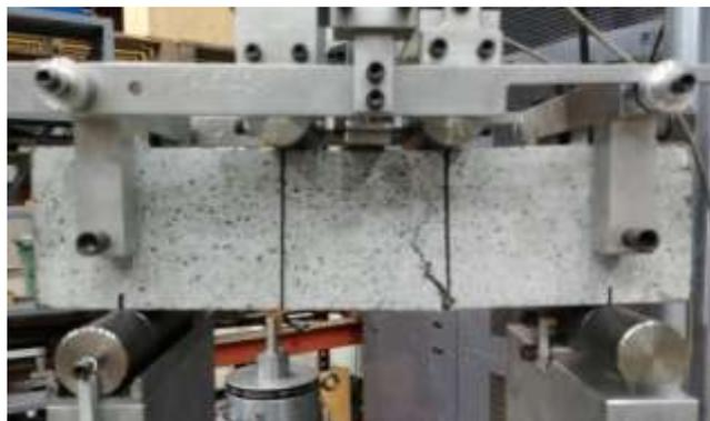
Montage pour l'essai de flexion à 4 points
