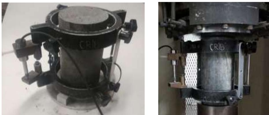
Figure 29 Échantillon avec instrumentation pour la mesure du module élastique
