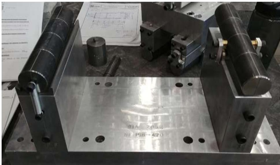
Figure 25 Banc d'essai pour les essais de flexion sur différents échantillons de BFUP
