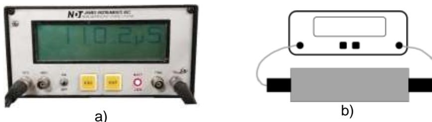
Figure 26 a) Détecteur ultra-sonique V-Meter Mk II et b) positionnement des capteurs sur l'axe longitudinal de l'échantillon
