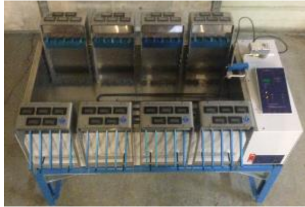
Figure 8: Machine d'essai pour la SCG selon ASTM F2136, ASTM F1473 et FM 5-572 (BT TECHNOLOGY INC.)
