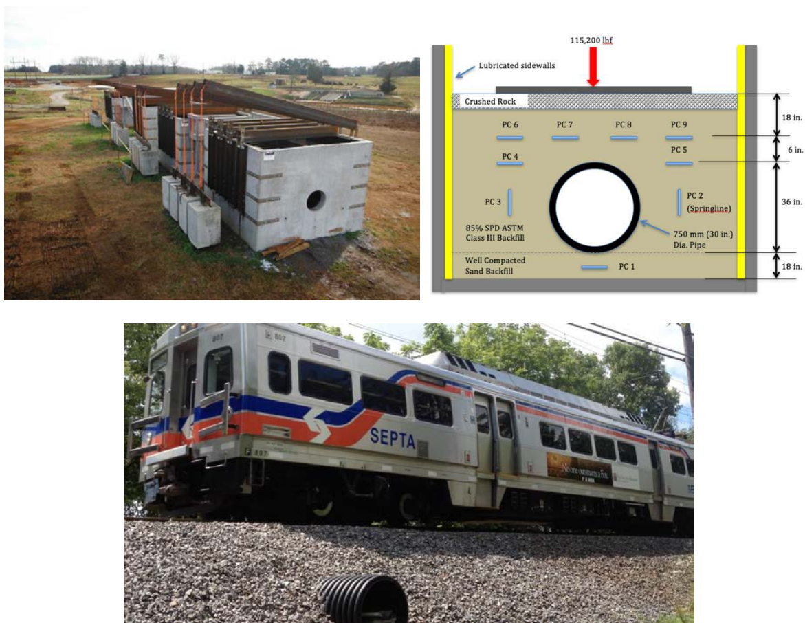
Figure 16: Performance sur le terrain de tuyaux en PEHD fabriqués avec et sans résine recyclée (Pluimer et al. 2018).
