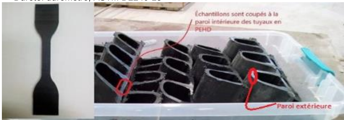
Figure 22: Forme d'haltère d'échantillons de traction (Paroi intérieure)
