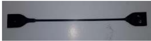
Figure 36: Mode de rupture typique des spécimens en PEHD après l'essai SIM (A-V spécimen)
