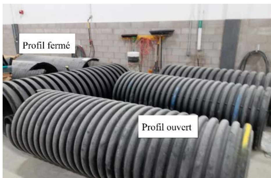
Figure 17: Tuyaux en PEHD de 900 mm de diamètre.
