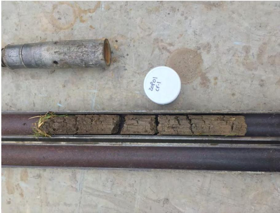
**PHOTO 1** Sols prélevés au droit du sondage 20PO1 (échantillon 20PO1-CF1).
