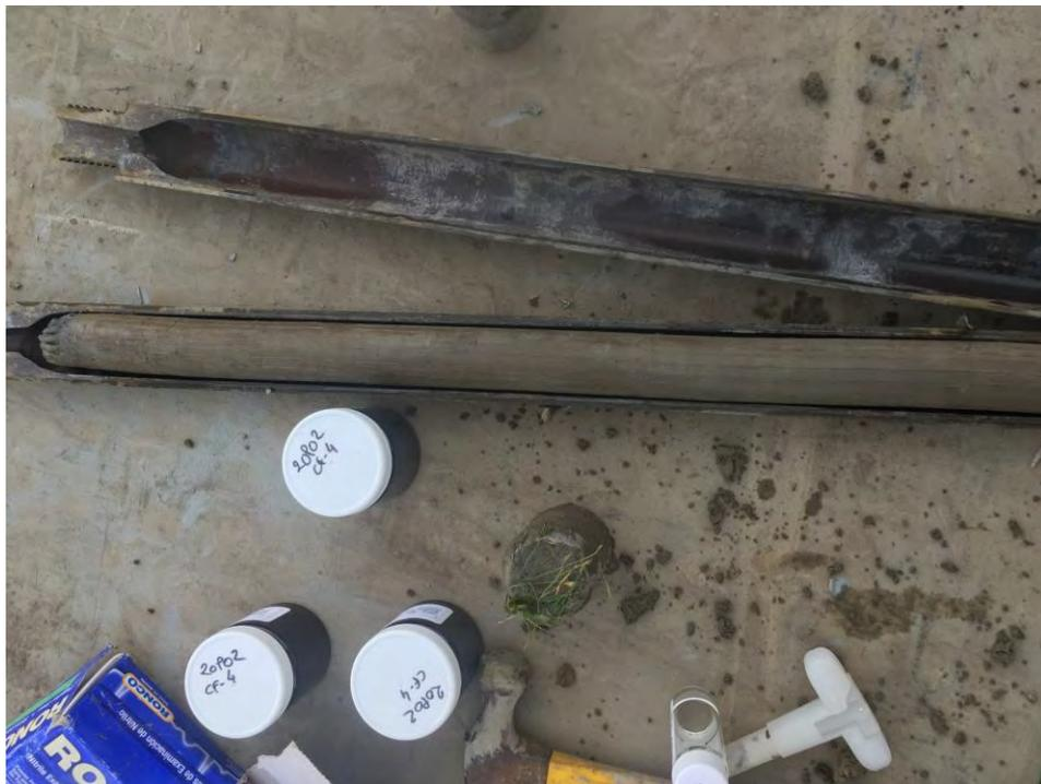
**PHOTO 4** Sols prélevés au droit du sondage 20PO2 (échantillon 20PO2-CF4).
