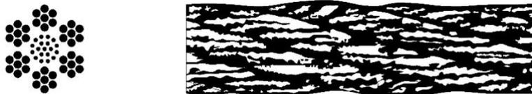
Figure 5.05 : Principe des câbles torsadés
