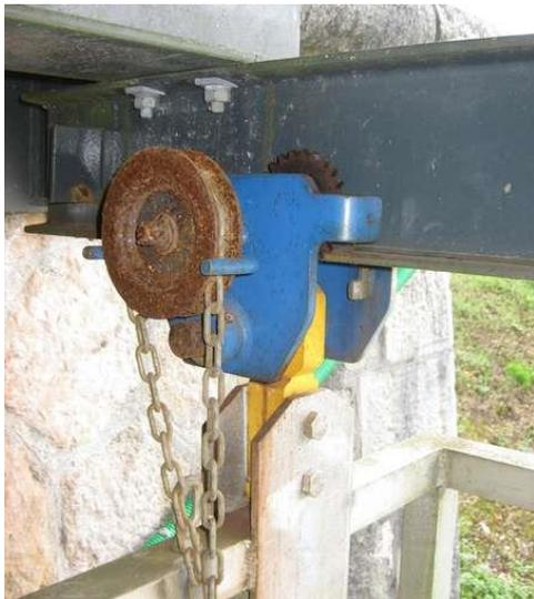
Figure 13.09 : Traction par chaîne
