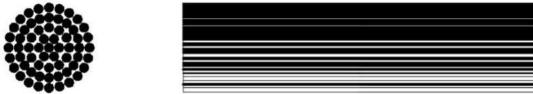
Figure 5.04 : Principe des câbles à fils parallèles
