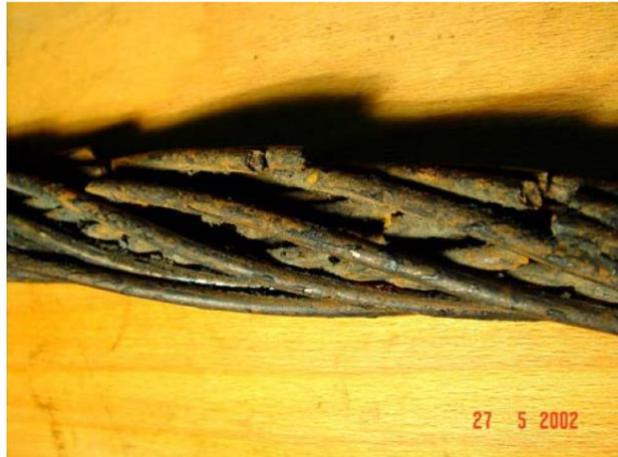
Figure 10.10 : Ruptures de fils internes à un toron dont la couche externe ne présentait pas de rupture.
