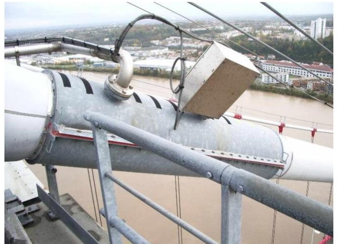
Figures 9.07 et 9.08 : Exemples de sondes disposées sur le pont d'Aquitaine
