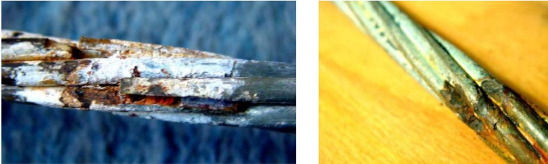
Figures 10.08 et 10.09 : Effets du couplage zinc/acier à proximité d'un ancrage
