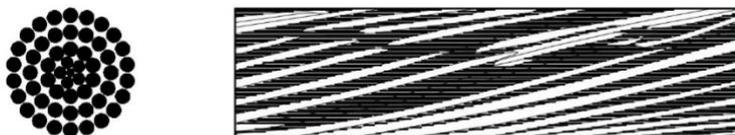
Figure 5.06 : Principe des câbles toronnés
