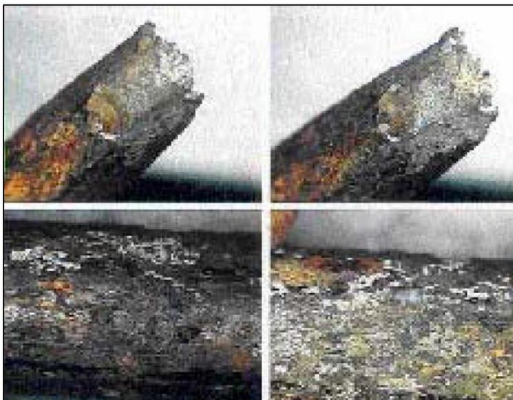
*Figures 10.27 à 10.30 : Fils rompus sur des fissures propagées par fatigue mais initiées par des piqûres de corrosion.*
