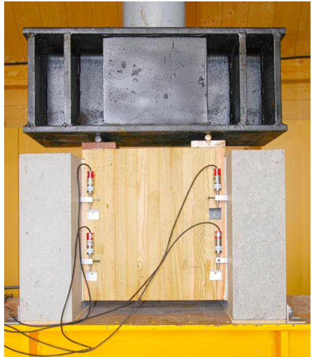
Photo 3 : Réalisation de l'essai push-out
