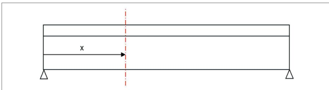
Figure 22 : Repérage d'une section de poutre isostatique soumise à de la flexion
