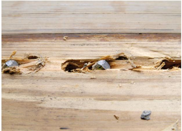
Figure A1-9 : Faciès de rupture pour le connecteur à plaque
