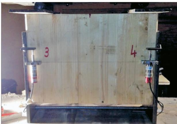
Photo 4 : Géométrie de l'essai push-out avec uniquement plaque métallique
