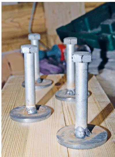
Figure A1-2 : Tirefonds avec rondelle soudée
