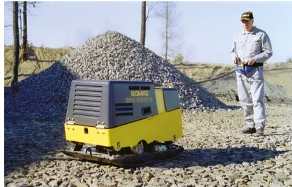
L'ensemble des plaques est classé PQ1 à PQ4 dans la Note technique « *Compactage des remblais de tranchées* » (SETRA-LCPC).
