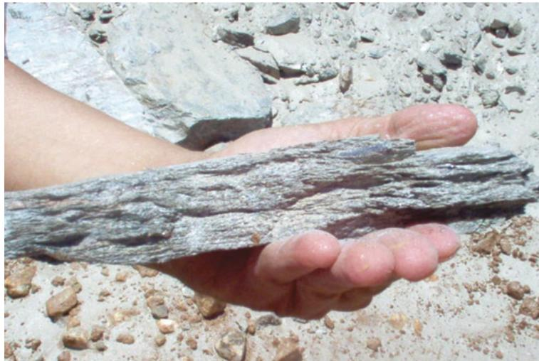
En géotechnique, la dimension la plus utilisée est le diamètre, qui correspond non pas à la plus grande longueur, mais à la dimension pour laquelle le bloc passerait au travers d'une maille de tamis, ce qui peut équivaloir à l'une des plus petites dimensions dans le cas de blocs allongés. L'utilisation d'autres dimensions que le  $D_{max}$  s'avère particulièrement intéressante pour le réemploi de certains matériaux :
