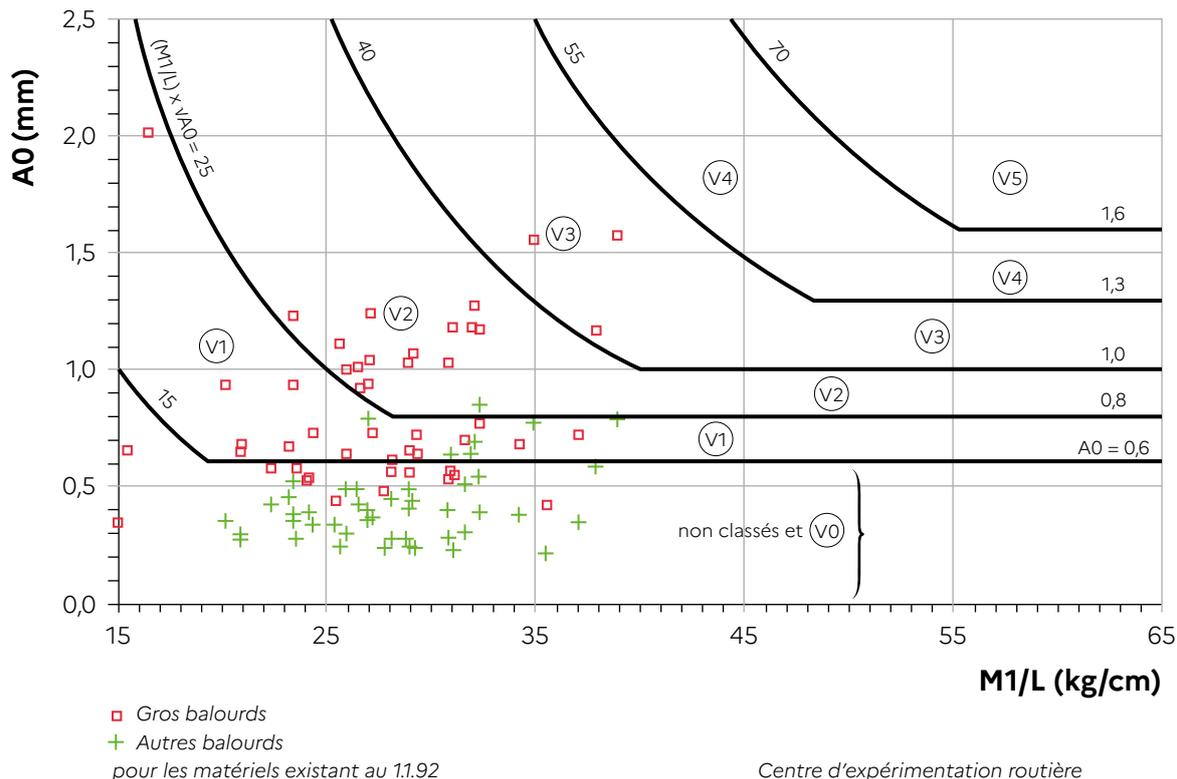
A0 peut être contrôlée par la méthode des coussins selon la norme NF P98-761 « Essai de vérification du moment des excentriques des compacteurs vibrants ».
