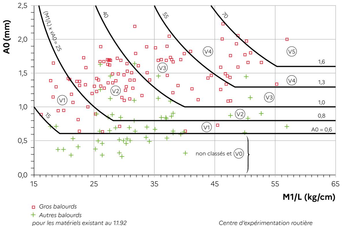
Figure 15: Diagramme de classement des compacteurs vibrants tandems
