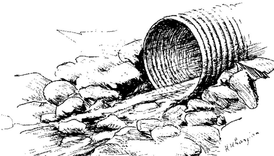
**Fig. 17** Déversement d'enrochement pour combler une rupture de pente à la sortie d'un ponceau
