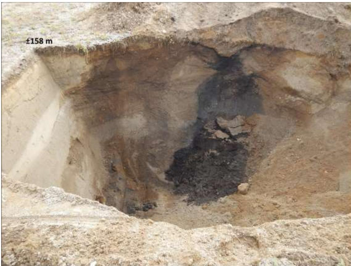
**Figure 69 : Infiltration d'huile visible dans la paroi est de la tranchée TR-09-20.** (Source : *Subarctique Enr.*, DSCN1167, 2020-08-05)
