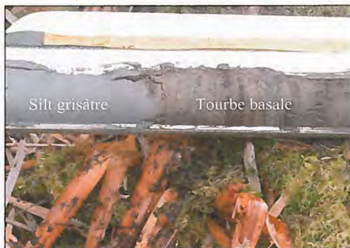
Figure 20. Section basale de la carotte montrant la transition entre les silts et la tourbe.
