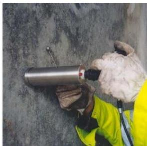
Figure 3.2- Exemple de mesure par la méthode impact-écho
