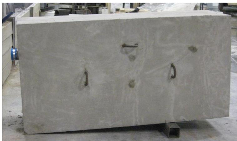
Figure 5.16- Bloc A : mise en place pour le remplissage de coulis
