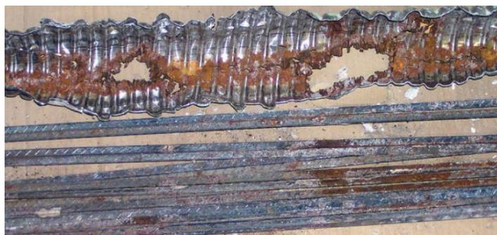
Figure 1.2- Gaine sévèrement corrodée dont l'acier avait commencé à se corroder [5]
