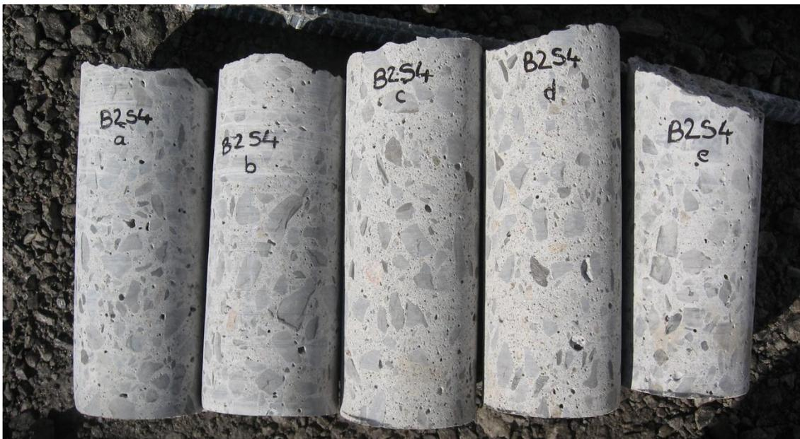
Figure 6.44- Carottes obtenues du segment de poutre B2S4
