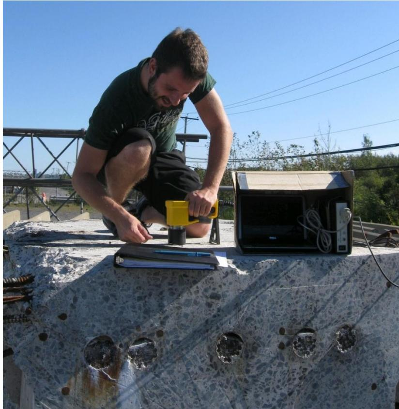
Figure 5.55 - Exemple de prise de mesure IE sur le segment de poutre B2S3 au-dessus de la gaine C
