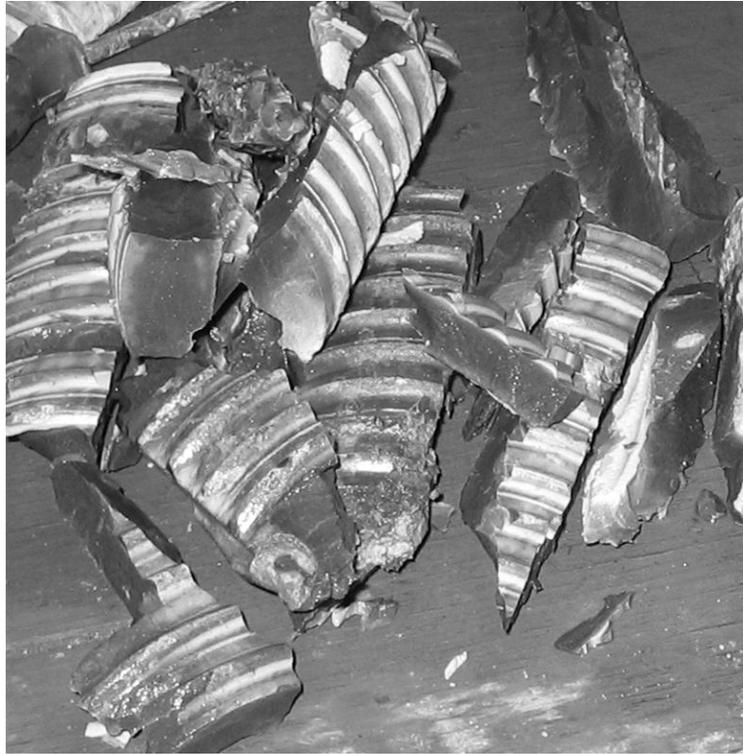
Figure 6.54- Echantillons de coulis de la gaine B4S4E entre les cotes 110 et 180
