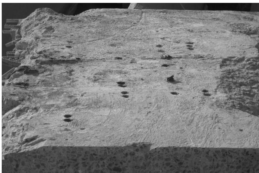
Figure 6.38 - Segment de poutre B2S3 percé en différents endroits d'étude pour l'endoscopie
