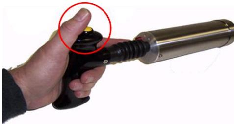
Figure e- Vue sur le bouton presseur (au niveau du pouce de l'utilisateur) sur le capteur « droit ».
