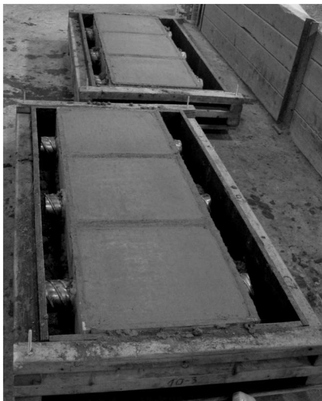
Figure 5.1- Fabrication des plaques (en haut : les 3 plaques PL1, en bas : les 3 plaques PL3)
