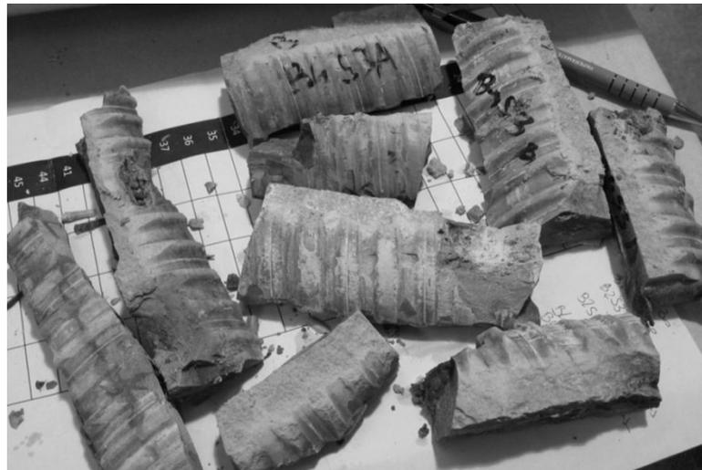
Figure 6.53- Échantillons de coulis récupérés à l'intérieur de la gaine B4S3A entre les cotes 75 et
