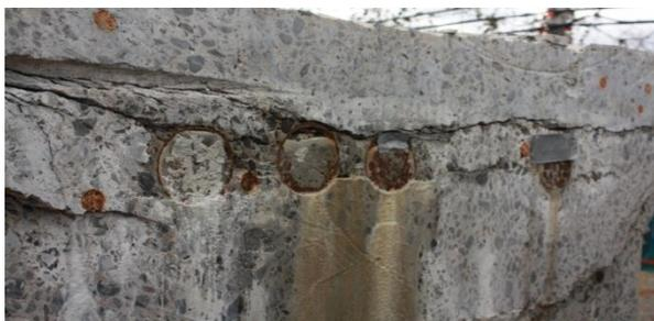
Figure 5.27- Vue sur le plan de fissuration (côté Nord) du segment de poutre B4S3
