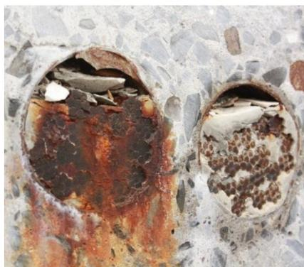
Figure 5.26- Gros plan sur les gaines A et B (voir figure 5.28) du segment de poutre B2S3
