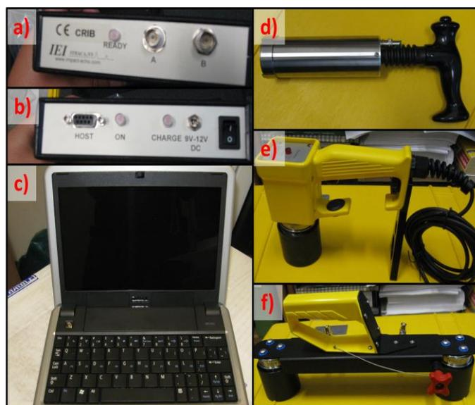
Figure 5.40- Différentes parties et capteurs de l'appareil impact-écho
