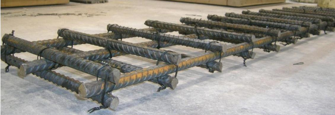
Figure 5.11- Photographie du "treillis" utilisé pour le bloc D
