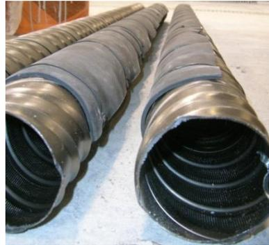
Figure 5.12- Film de caoutchouc placé sur les gaines DB et DC pour simuler la présence d'un plan de fissure.
