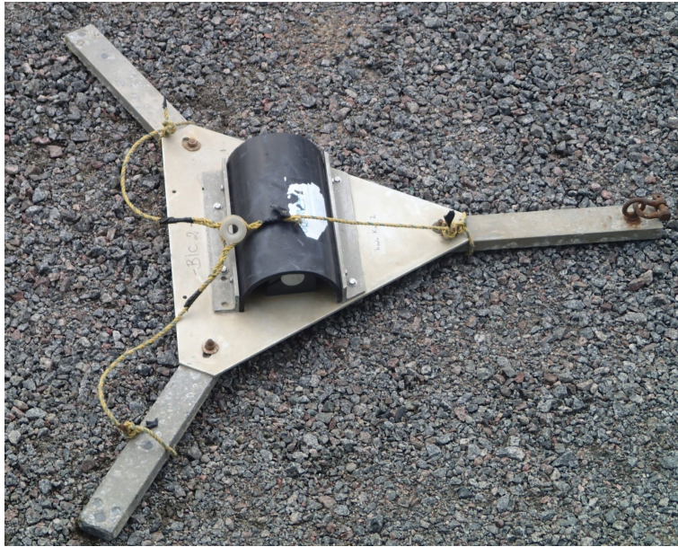
Figure 11. Support de mouillage utilisé pour les houlographes TWR-2050 à Kuujjuarapik
