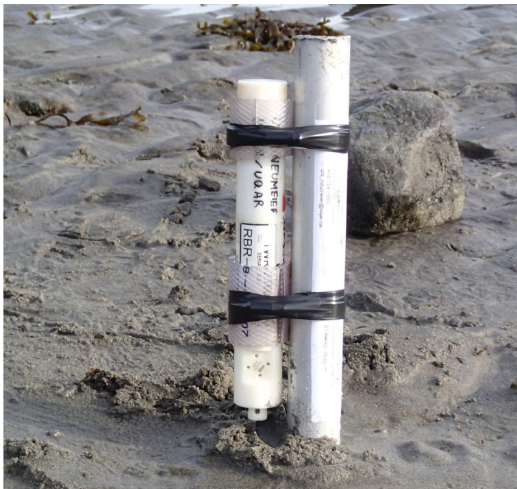
Figure 12. Fixation du houlographe TWR-2050 à Quaqtak.
